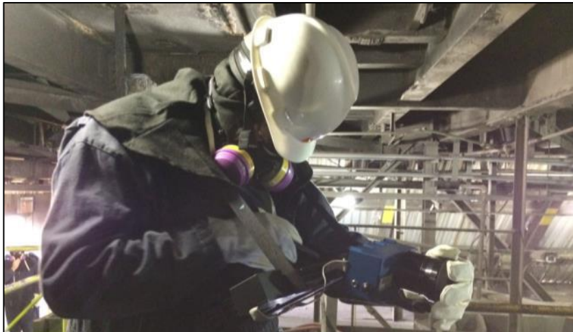
Inspección de SO 2 en la fundición de MacMoran, Arizona, USA
