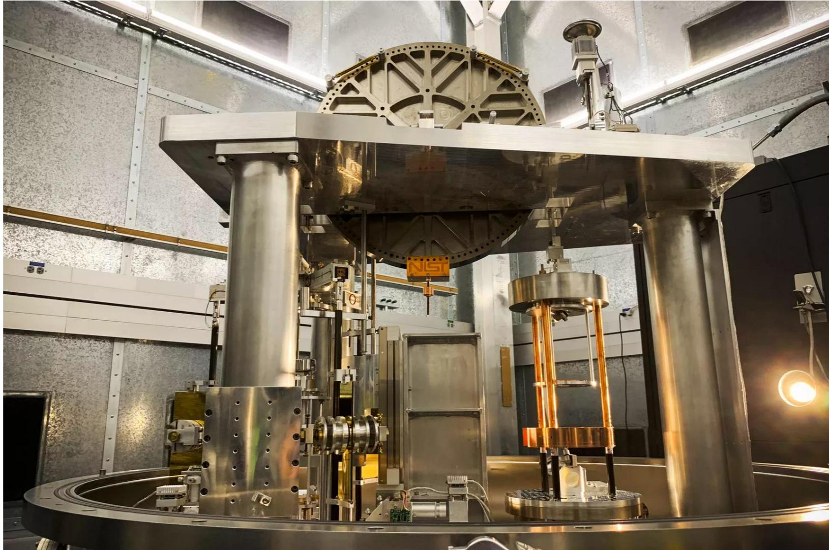
**La balanza Kibble es una máquina increíblemente complicada y hermosa que compara la potencia mecánica con la potencia eléctrica.**
