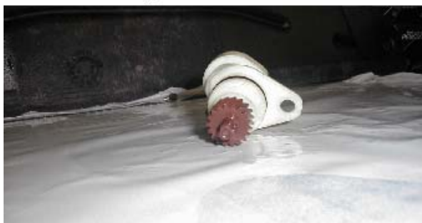
Piñón del captador de velocidad
