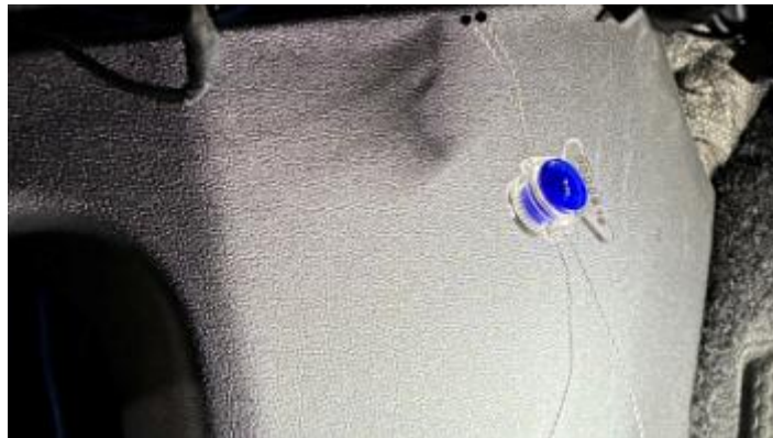
Figura 13. Precinto montante A zona tirador puerta capó (Concesionario oficial)
