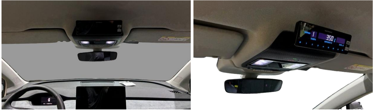
Figura 19 y 20. Ejemplo de taxímetro instalado en el módulo techo.
