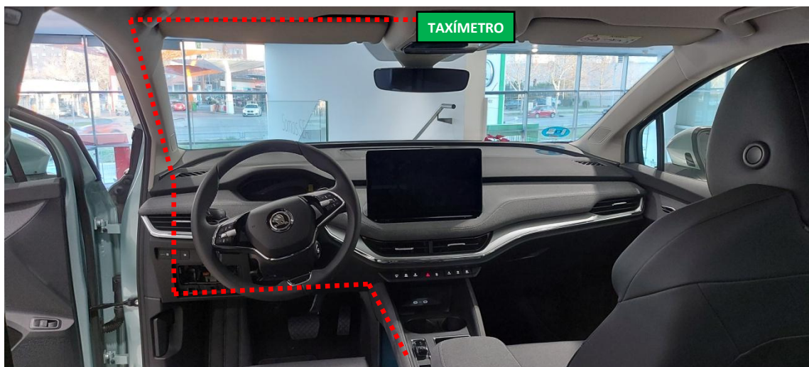
Figura 24. Recorrido del cable de impresora.
