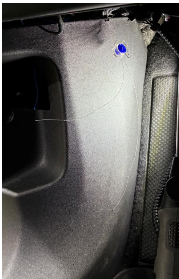
Figura 12. Detalle del embellecedor taladrado y precintado.
