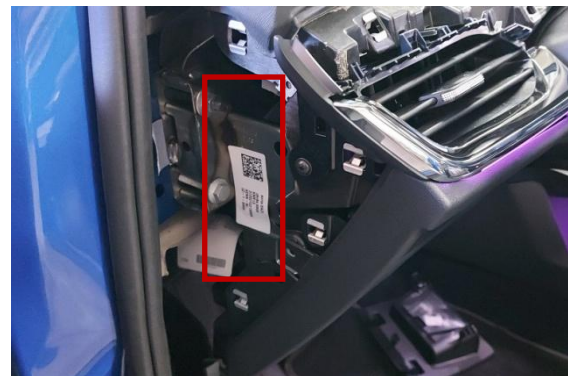
Figura 4. Ubicación caja de conexiones.
