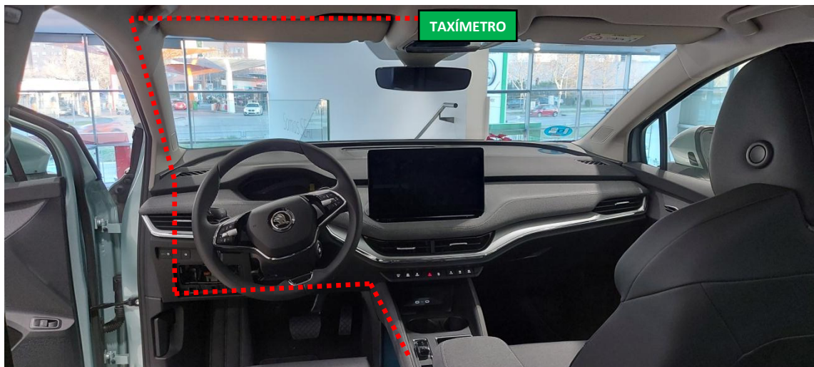
Figura 24. Recorrido del cable de impresora.
