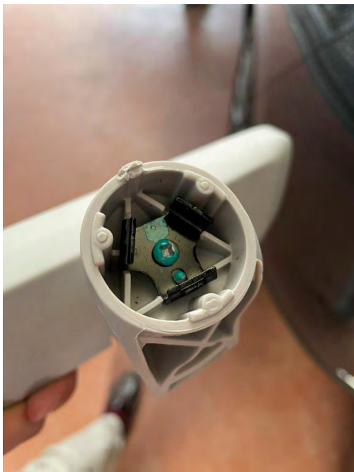
Figura 4.2.4.8 y 4.2.4.9.: Vistas de la rótula de fijación del retrovisor original al parabrisas.
