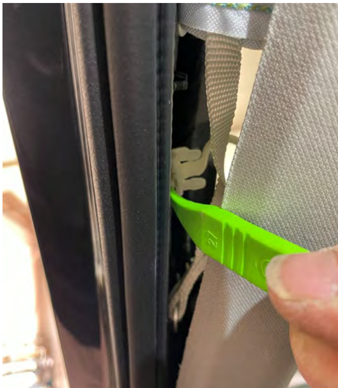
Figura 4.2.4.2: Desmontaje del guarnecido del pilar A izquierdo
