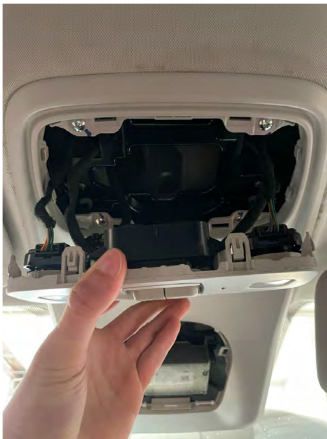
Figura 4.2.4.7: Vista de desmontaje de los paneles a intervenir
