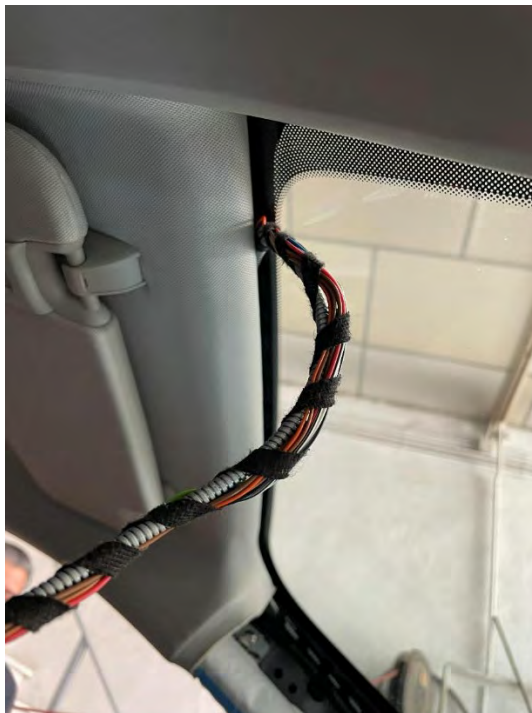
Figura 4.2.4.5: Paso de cables del taxímetro por el interior del techo
