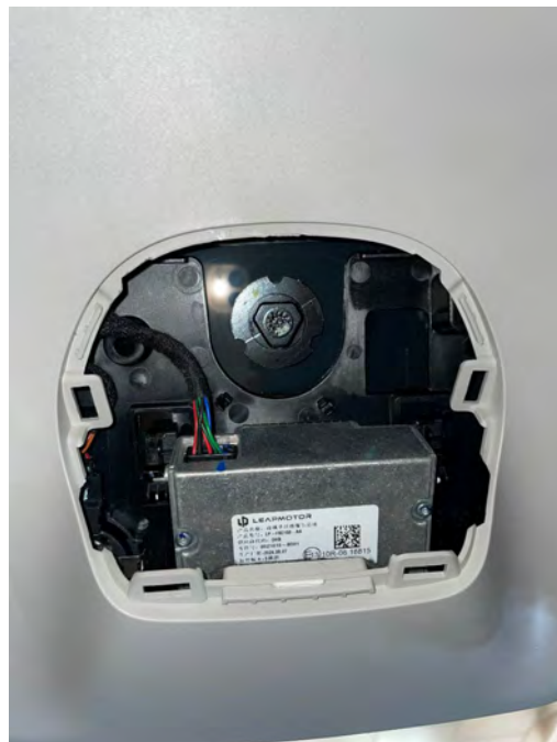
Figura 4.2.4.8 y 4.2.4.9.: Vistas de la rótula de fijación del retrovisor original al parabrisas.
