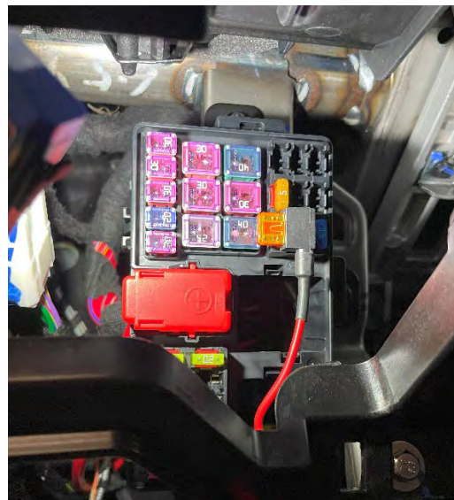
Figuras 3.3.1.13 y 3.3.1.14: Vista de caja de fusibles y la ubicación de los RF10 para +30 y RF14 para +15
