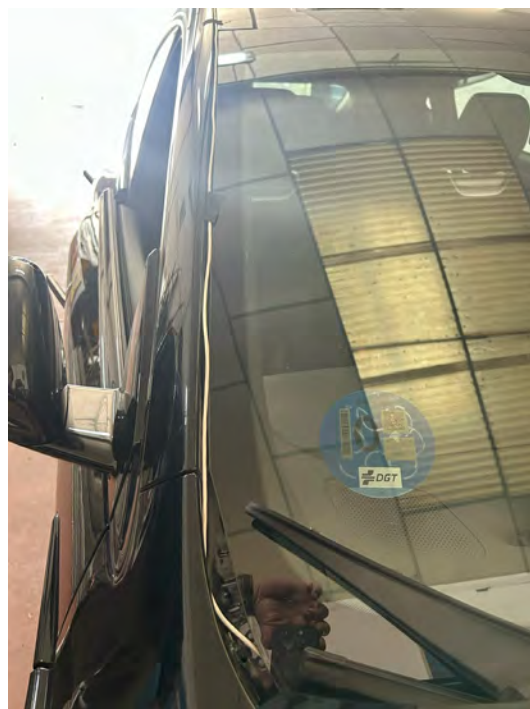
Figura 4.2.6.6: Recorrido del cable por el vierteaguas
