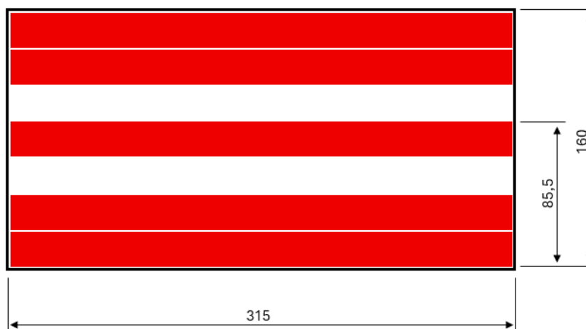
Figura 2. Posición y longitud de las tiras de cinta adhesiva de doble cara
