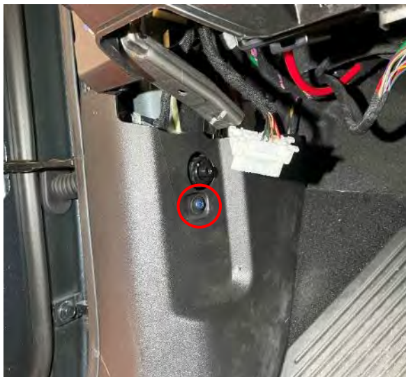
Figuras 3.3.1.6 y 3.3.1.7: Tornillos de sujeción del panel inferior del pilar A.
