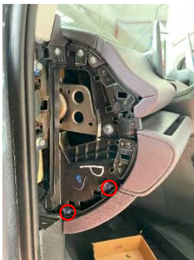
Figura 3.3.1.4: Guarnecido lateral del salpicadero retirado
