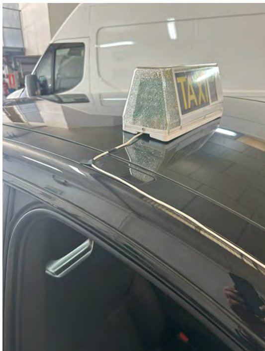
Figura 4.2.6.15: Recorrido del cable sobre el techo
