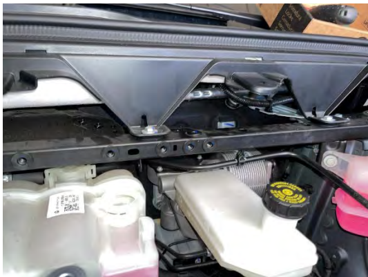
Figura 4.2.6.19: Detalle de zona del paso del cable bajo el embellecedor del cofre motor
