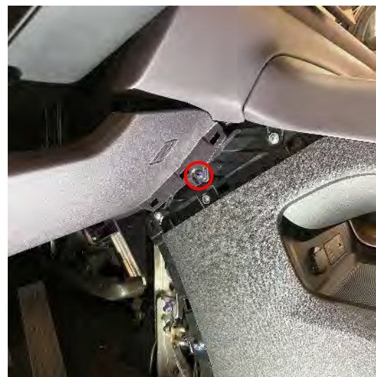
Figura 3.3.1.5: Guarnecidos laterales de la consola central retirados
