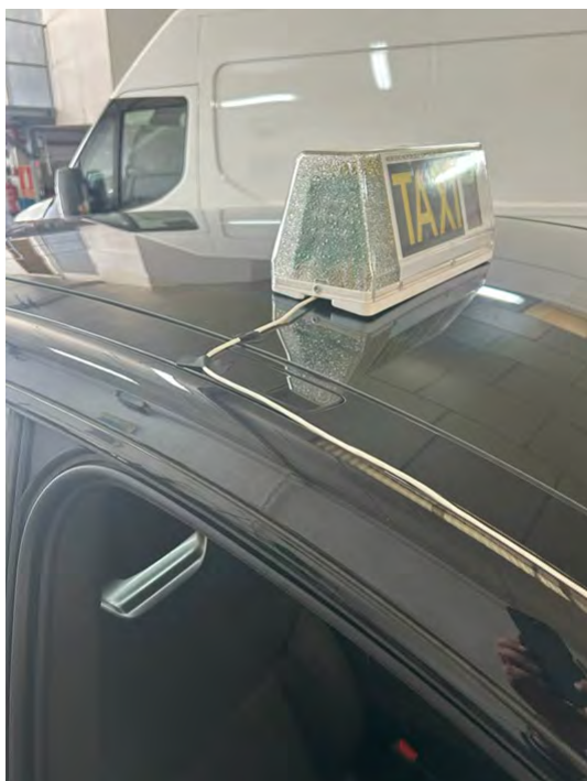
Figura 4.2.6.5: Recorrido del cable sobre el techo
