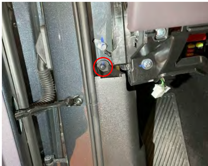
Figuras 3.3.1.6 y 3.3.1.7: Tornillos de sujeción del panel inferior del pilar A.
