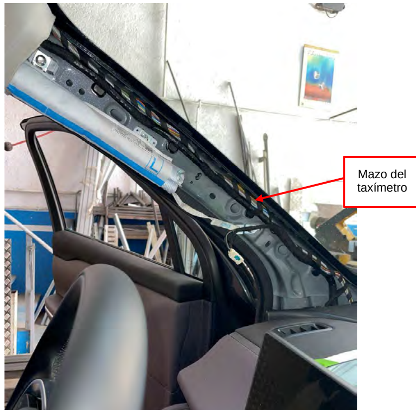
Figura 4.2.4.3: Recorrido del mazo del taxímetro por el interior del pilar A
