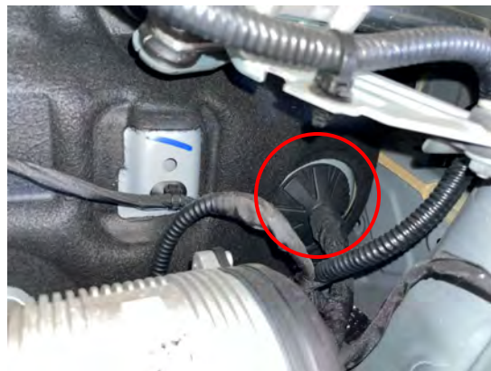
Figura 4.2.6.10: Vista del pasamuros desde el compartimento motor
