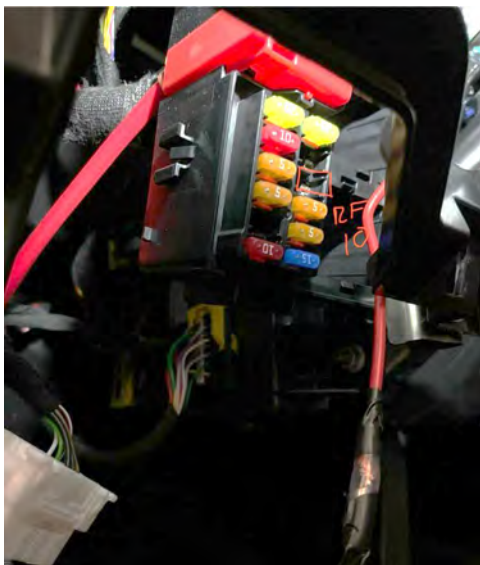
Figuras 3.3.1.13 y 3.3.1.14: Vista de caja de fusibles y la ubicación de los RF10 para +30 y RF14 para +15
