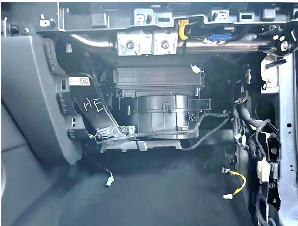
Fig. 3.4.1.9. Despanelado completo para el acceso al Right Body Domain Control
