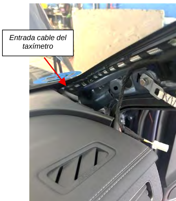
Fig. 5.3.10. Entrada del cable del taxímetro al salpicadero.
