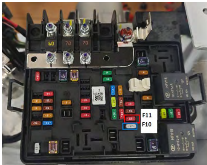
Fig. 3.4.3.5. Ubicaciones fusibles para toma de señal de contacto positivo bajo llave (+15).
