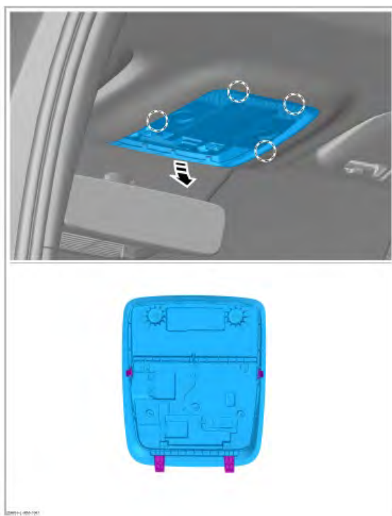
Fig. 5.5.1.6 y 5.5.1.7. Desmonaje del cuerpo del plafón
