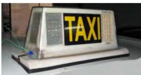
Fig. 4.2.6.2.6. Ejemplo de módulo tarifario con precinto
