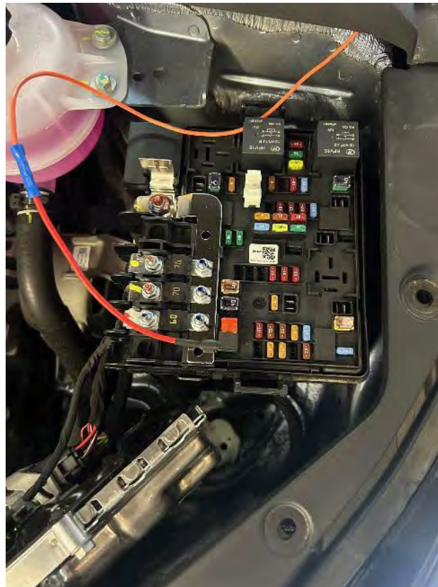
Fig. 3.4.3.4. Vista de la línea +12V conectada en la caja delantera de fusibles.
