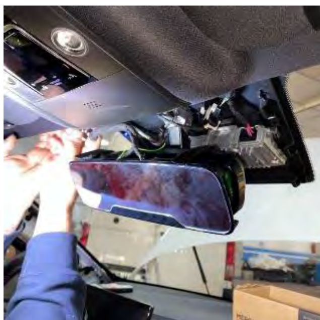
Fig. 5.3.7 y 5.3.8. Instalación del cable del taxímetro por el interior del techo
