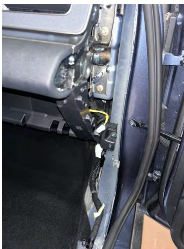
Fig. 3.4.1.7. Vista del panel lateral del salpicadero desmontado
