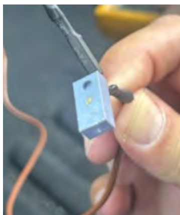
Fig. 3.4.2.5. Ejemplo de resistencia terminal (120 Ohm)
