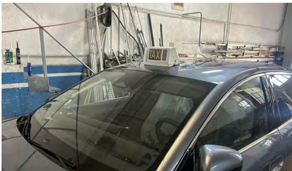
Fig. 5.5.2.1. Vista delantera exterior del módulo tarifario desplazado.
