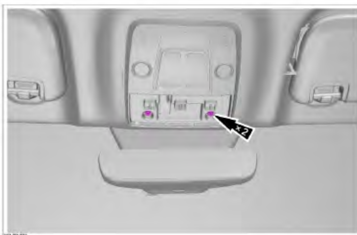
Fig. 5.5.1.5. Desmonaje de los tornillos
