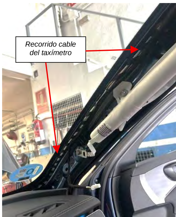
Fig. 5.3.9. Recorrido del cable del taxímetro por el marco del parabrisas
