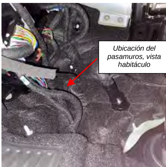
Fig. 3.4.3.7. Vistas del pasamuros interior del habitáculo
