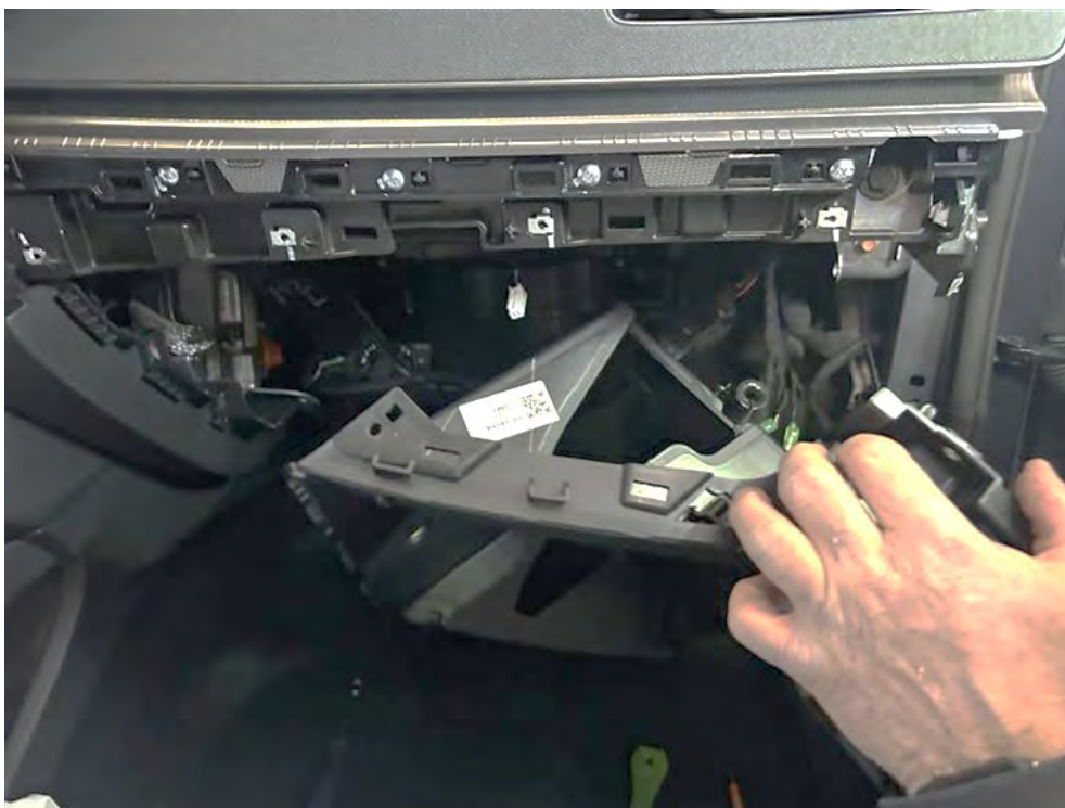
Fig. 3.4.1.8. Panel frontal del salpicadero desmontado y retirada del bastidor de la guantera
