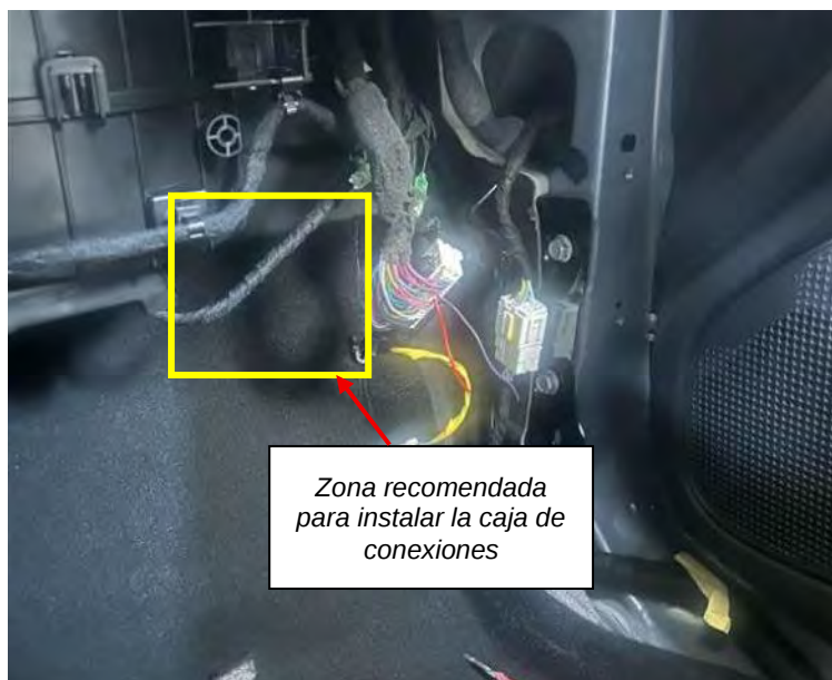
Fig. 5.2.1. Ubicación de la caja de conexiones
