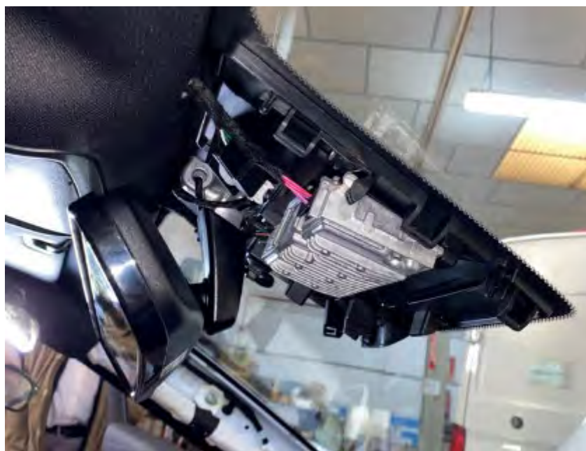
Fig. 5.3.4. Vista recubrimiento del soporte del retrovisor desmontado.
