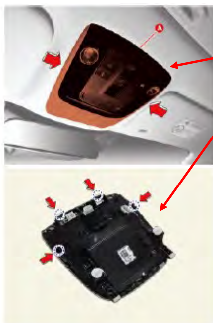
Desmontaje plafón interior y parasol
