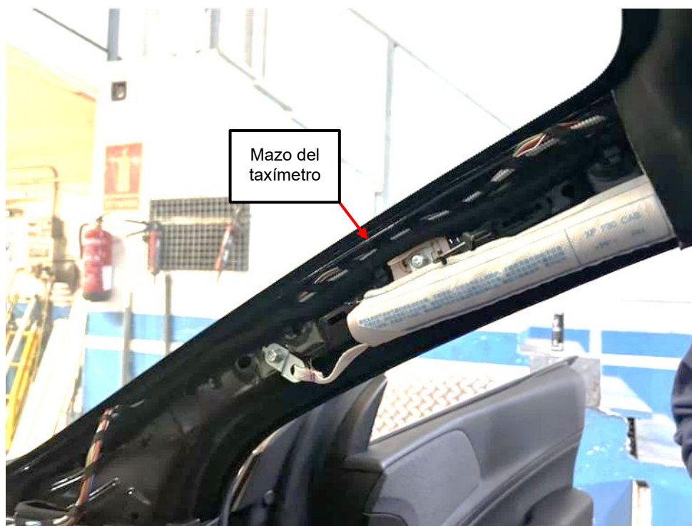
Figura 4.2.4.4: Recorrido del mazo del taxímetro bajando por el pilar A
