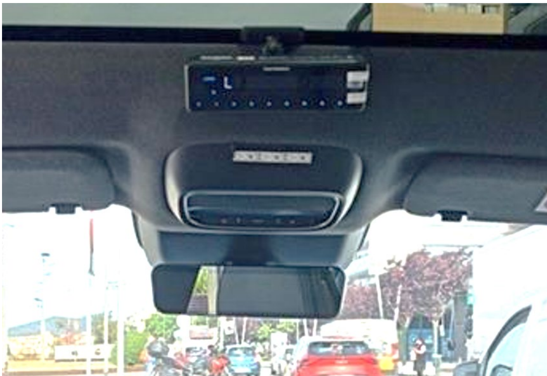
Figura 4.2.4.3: Vista del taxímetro de tablero en techo
