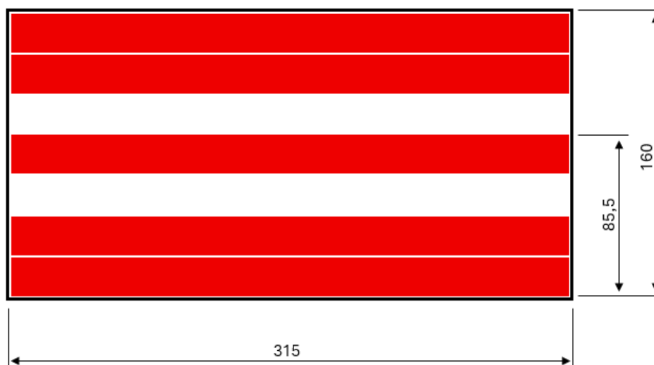
Figura 4.2.4.5. Posición y longitud de las tiras de cinta adhesiva de doble cara
