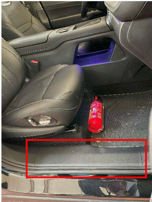
Figura 3.3.2.6: Panel inferior del umbral de puerta del acompañante
