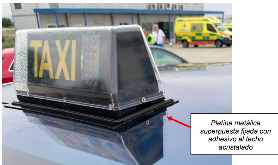
Figura 4.2.4.3. Detalle de pletina pegada
