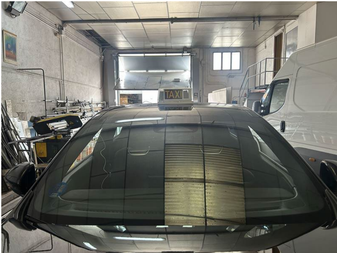
Figura 4.2.4.1: Módulo tarifario centrado sobre el techo
