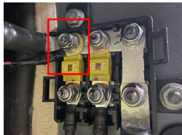
Figura 3.3.2.13. Positivo directo de batería (+30)
