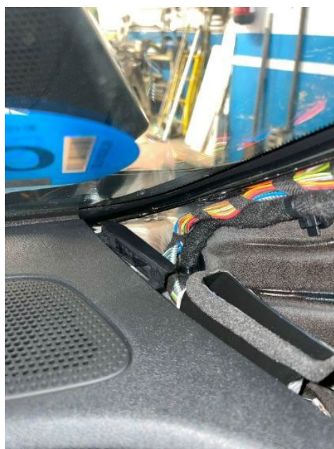
Figura 4.2.4.4: Entrada del mazo del taxímetro por el lateral del salpicadero
