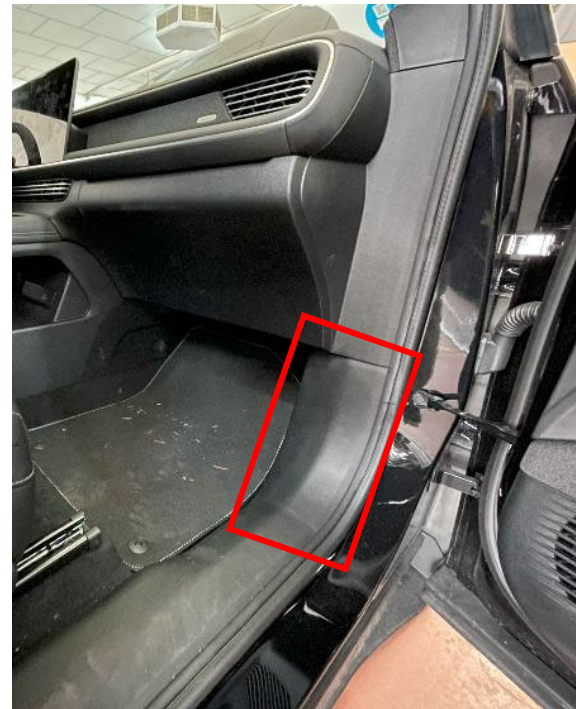
Figura 3.3.2.7: Panel inferior delantero del umbral de puerta del acompañante
