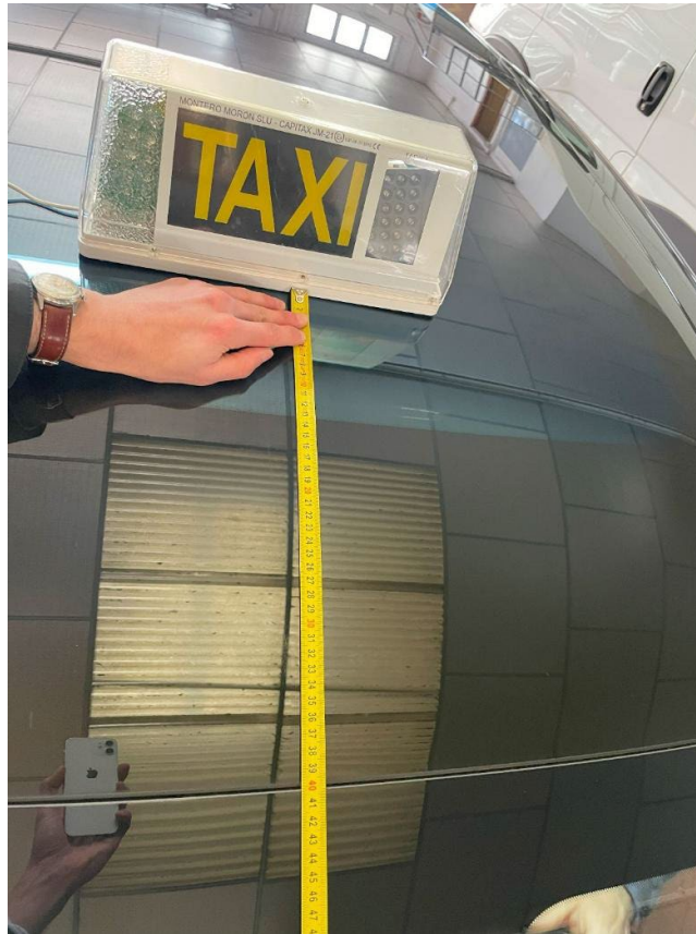
Figura 4.2.4.2: Módulo tarifario a 400 mm del borde del parabrisas
