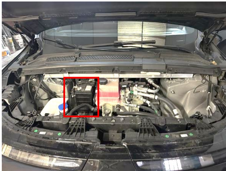
Figura 3.3.2.1. Ubicación de la batería de 12V
