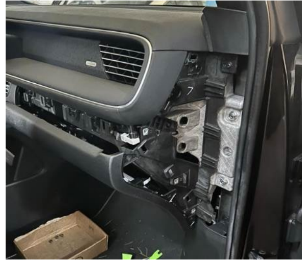
Figuras 3.3.2.4 y 3.3.2.5. Detalle de desmontaje del frente del salpicadero
