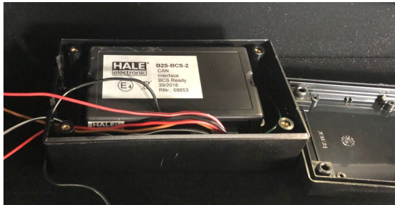
Figura 3.3.2.10 y 3.3.2.11. Vistas de la caja contenedora del conversor de impulsos (BCI) y forma de precintar
