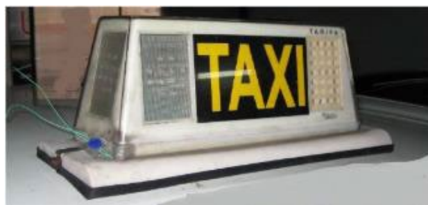
Figura 4.2.4.12. Vista de un módulo tarifario con precinto de instalador
