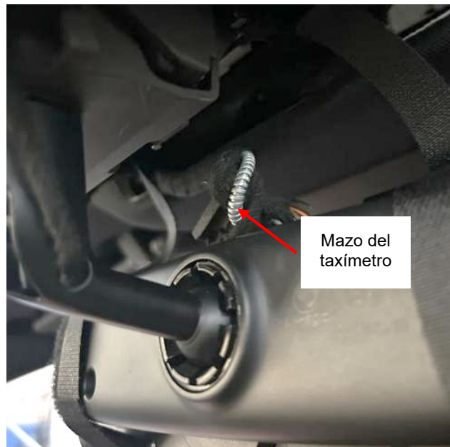
Figura 4.2.4.2: Recorrido del mazo del taxímetro de espejo hacia el interior del techo
