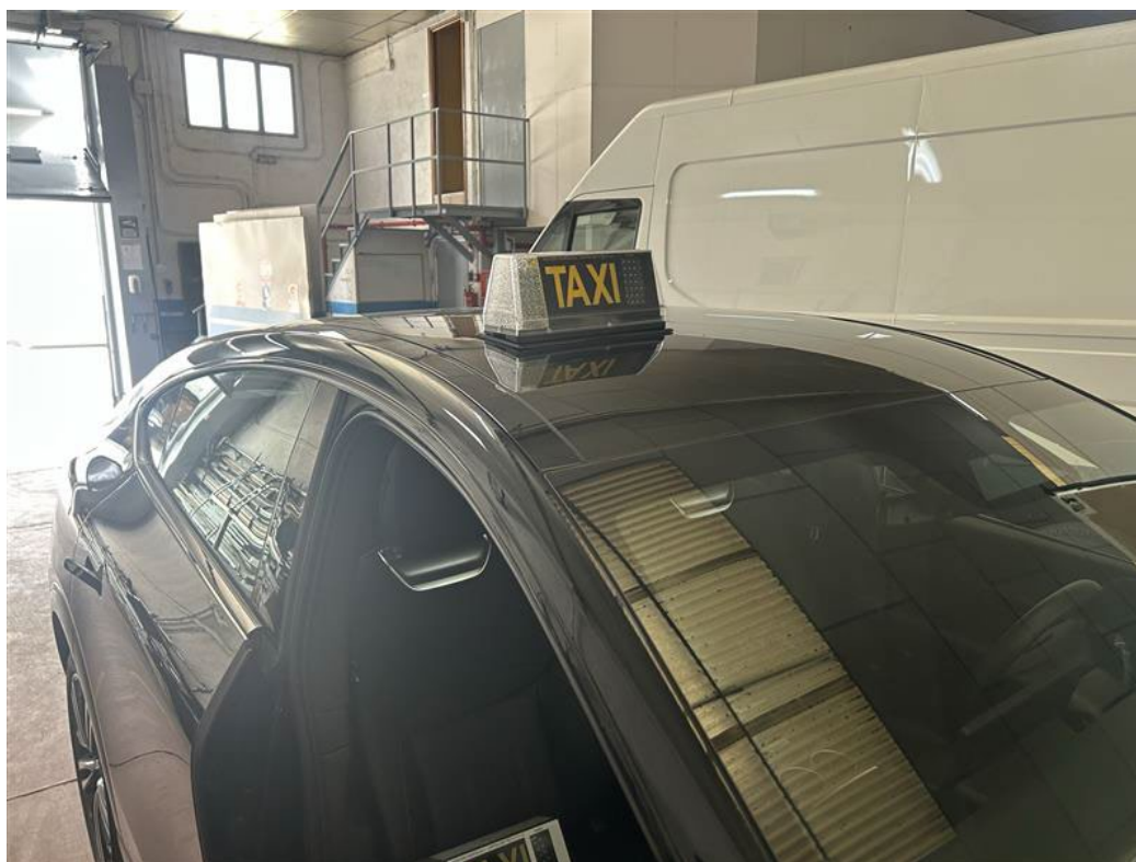
Figura 4.2.4.15: Módulo tarifario descentrado sobre base magnética
