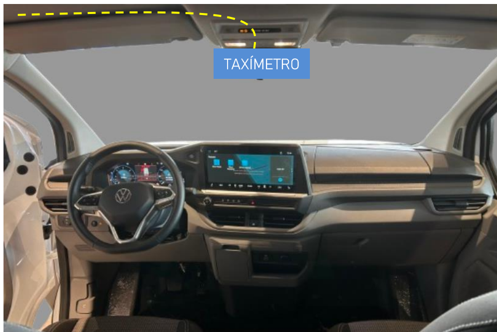
Figura 18. Trazado del cable del módulo tarifario.
