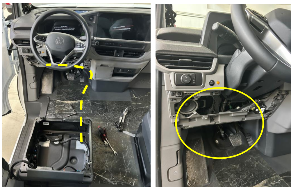
Figura 11 y 12. Recorrido cableado.
