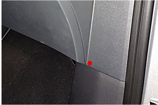
Figura 3.3.3.2: Posición del taladro sobre la tapa lateral del salpicadero
