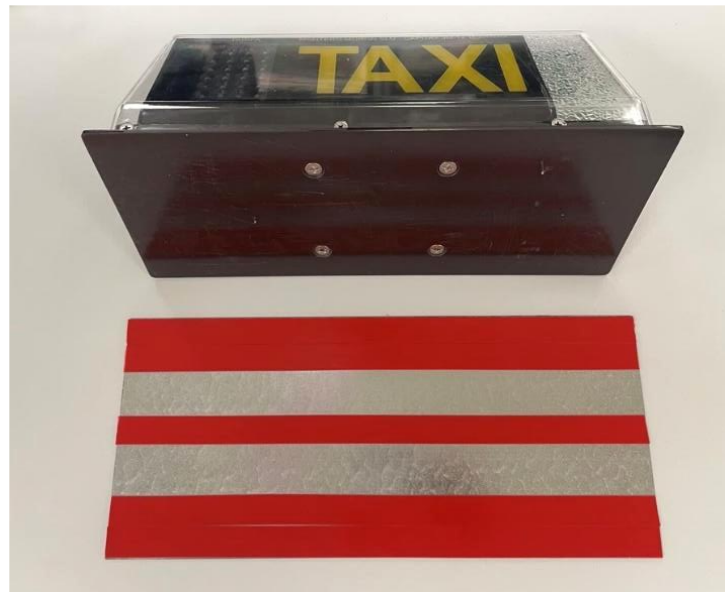
Figura 4.2.4.6. Vista de un módulo imantado y preparación del adhesivo en pletina metálica
