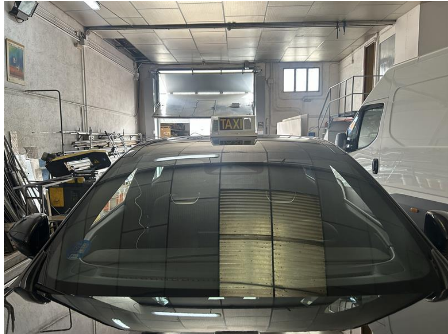
Figura 4.2.4.1: Módulo tarifario centrado sobre el techo
