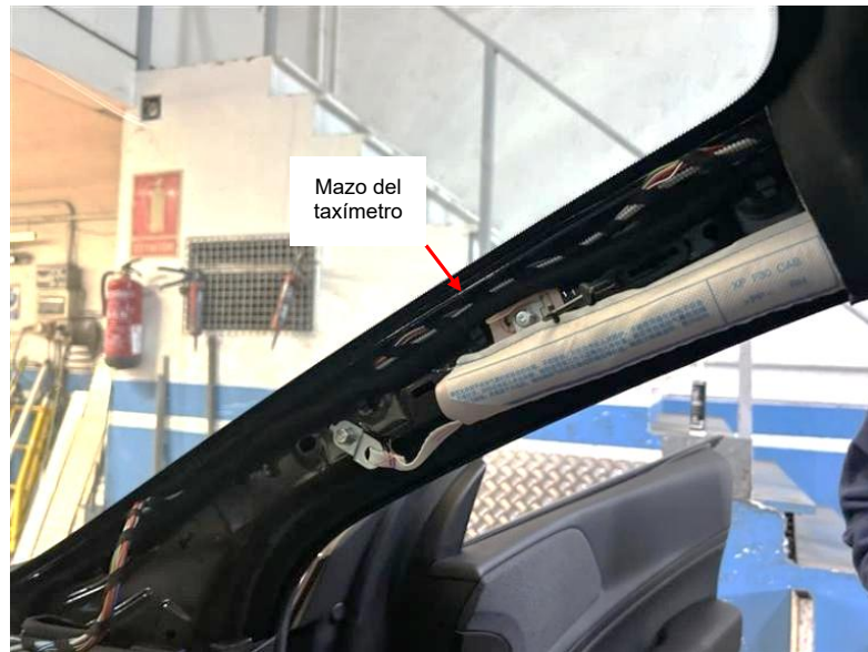
Figura 4.2.4.3: Recorrido del mazo del taxímetro bajando por el pilar A
