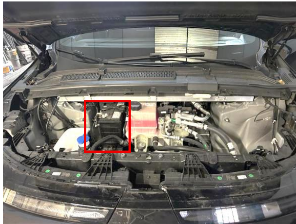
Figura 3.3.2.1. Ubicación de la batería de 12V
