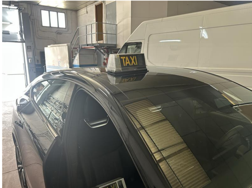
Figura 4.2.4.15: Módulo tarifario descentrado sobre base magnética
