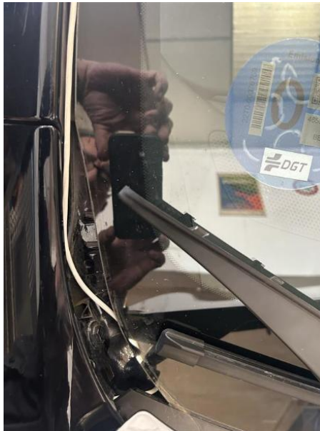
Figura 4.2.4.9. Detalle del cable del módulo bajo el torpedó
