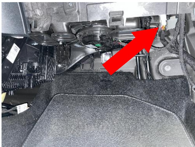
Figura 3.3.1.1. Emplazamiento del conector FBBDR
