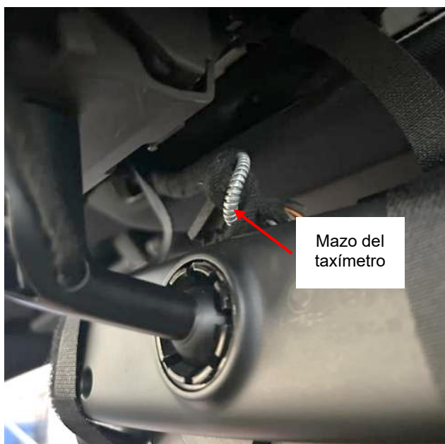
Figura 4.2.4.2: Recorrido del mazo del taxímetro hacia el interior del techo
