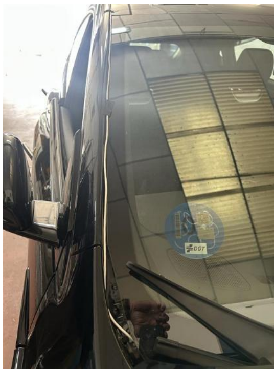
Figura 4.2.4.8. Recorrido del cable del módulo por el vierteaguas
