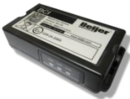
Figura 3.3.2.9. Ejemplo de caja convertidora de impulsos (BCI)
