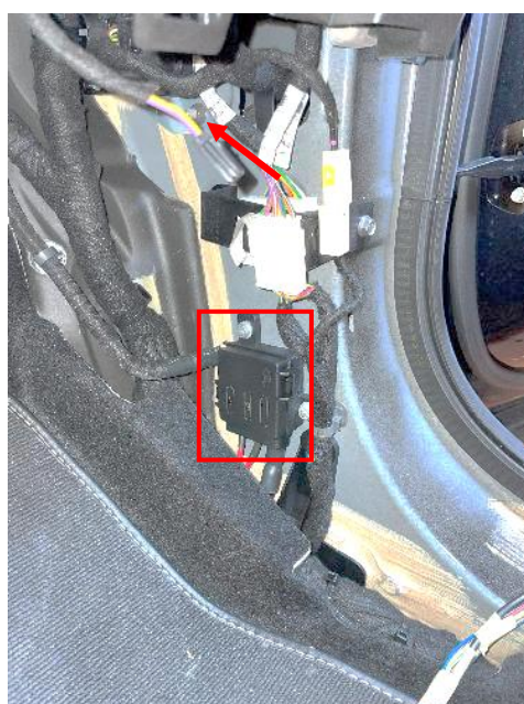
Figuras 3.3.1.6 y 3.3.1.7: Tuerca de toma de masa y caja de conexiones para toma de +30
