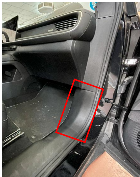
Figura 3.3.2.7: Panel inferior delantero del umbral de puerta del acompañante
