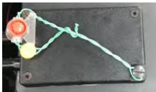
Figura 3.3.2.10 y 3.3.2.11. Vistas de la caja contenedora del conversor de impulsos (BCI) y forma de precintado
