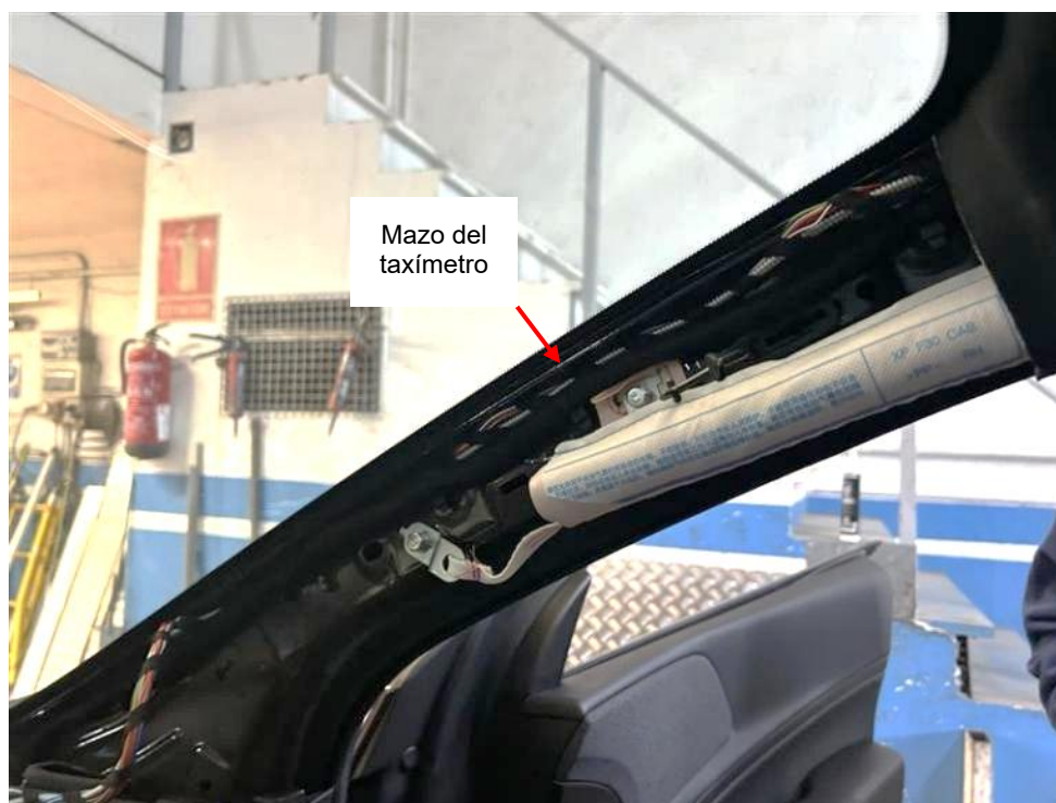
Figura 4.2.4.3: Recorrido del mazo del taxímetro bajando por el pilar A
