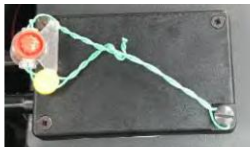
Figura 3.3.2.10 y 3.3.2.11. Vistas de la caja contenedora del conversor de impulsos (BCI) y forma de precintar
