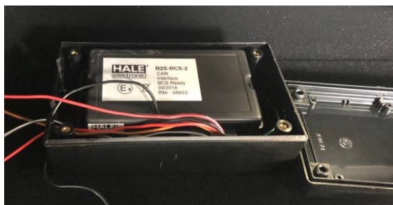
Figura 3.3.2.10 y 3.3.2.11. Vistas de la caja contenedora del conversor de impulsos (BCI) y forma de precintado
