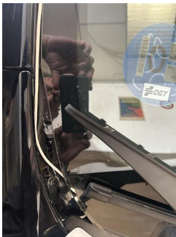
Figura 4.2.4.9. Detalle del cable del módulo bajo el torpedero
