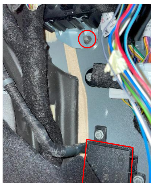
Figuras 3.3.1.6 y 3.3.1.7: Tuerca de toma de masa y caja de conexiones para toma de +30
