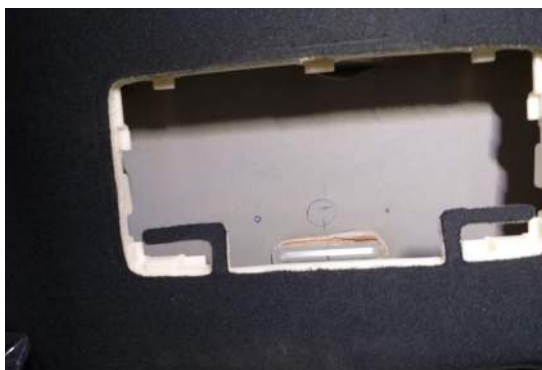
Detalle del hueco de luces de techo y pletina con tornillos y cable de la capilla
