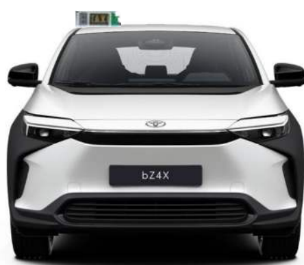
Ubicación módulo tarifario exterior magnético
