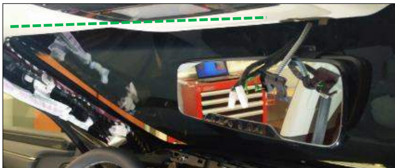
Recorrido del cable del módulo tarifario
