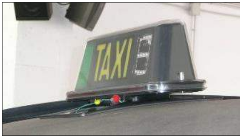
Ejemplos de capilla imantada con base magnética longitudinal y transversal
