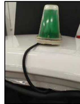
Ejemplos de recorrido del cable por el vierteaguas o por el interior de la puerta derecha.
