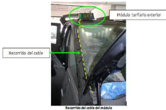
Ejemplos de recorrido del cable por el vierteaguas o por el interior de la puerta derecha.
