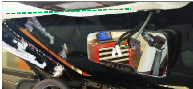
Recorrido del cable del módulo tarifario
