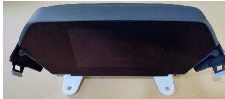
Vista general cuadro de instrumentos con sus cubiertas
