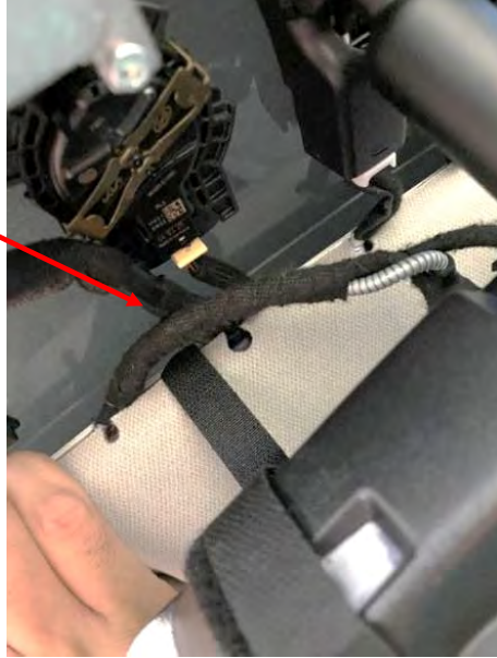
Salida cables Taxímetro
