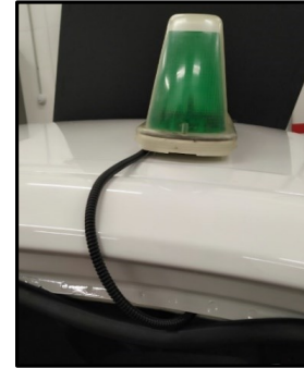
Ejemplos de recorrido del cable por el vierteaguas o por el interior de la puerta
