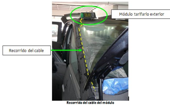
Ejemplos de recorrido del cable por el vierteaguas o por el interior de la puerta
