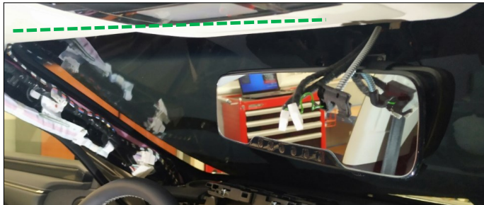
Ejemplo recorrido del cable del módulo tarifario
