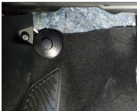
Pulsador de emergencia
