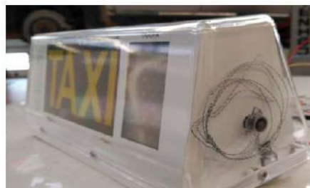
Ejemplo de precinto incorporado en el módulo tarifario
