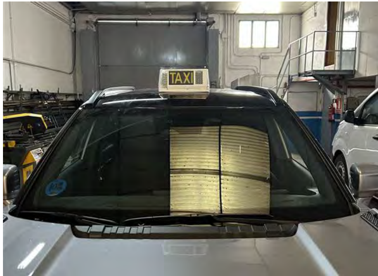
Figura 4.2.6.1: Módulo tarifario centrado sobre el techo
