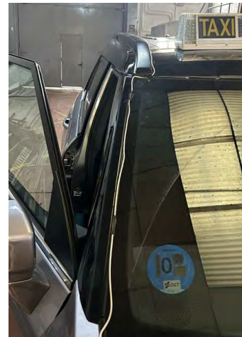
Figura 4.2.6.9: Cable pel vierteaguas
