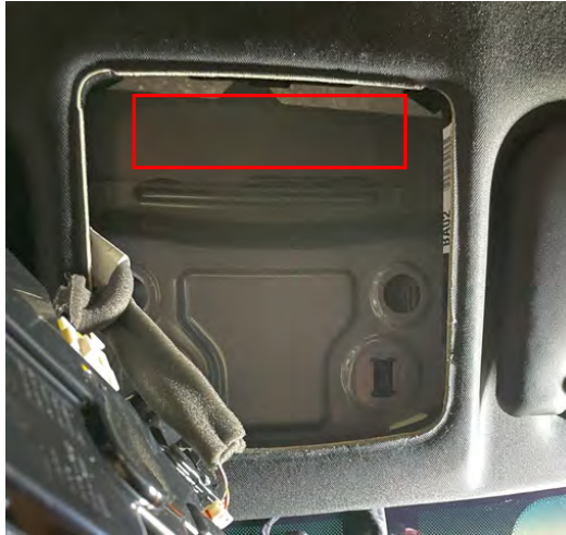
Figura 4.2.6.5: Zona recomendada para los taladros para el módulo tarifario atornillado
