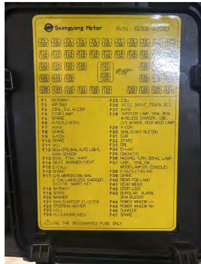
4.2.3.2: Identificación de fusibles
