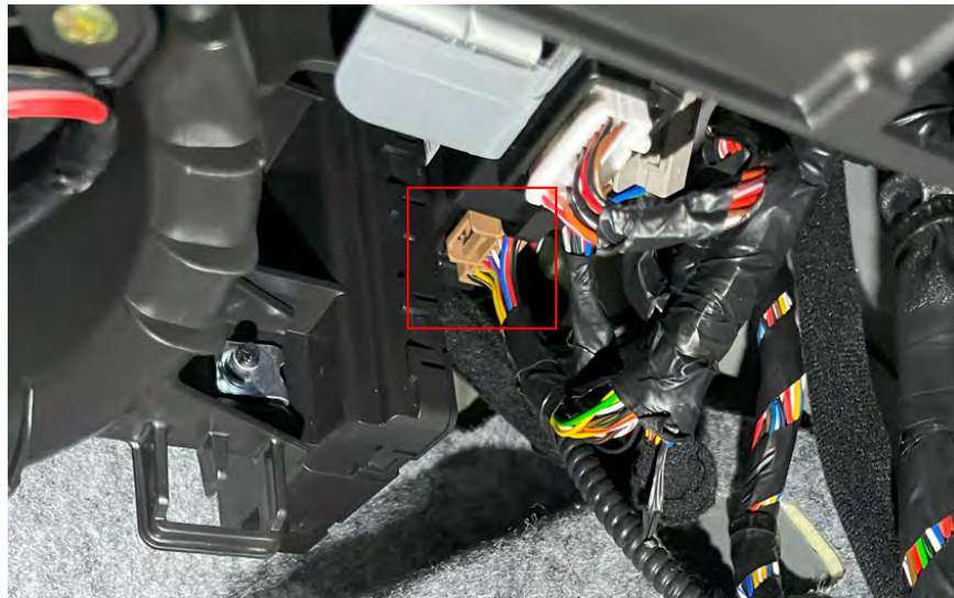
Figura 3.3.2.1: Vista del conector A del SKM
