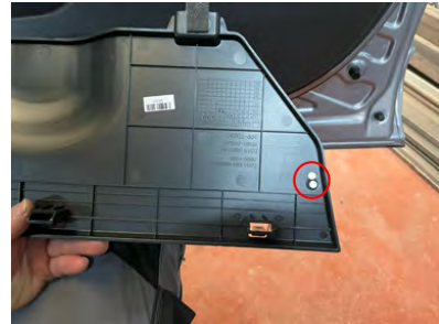
Figuras 3.3.3.1: Posición de los taladros para el precinto del concesionario
