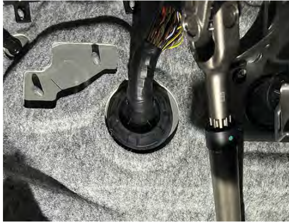
Figura 4.2.6.14: Vista del pasamuros desde el interior junto al cardan de dirección
