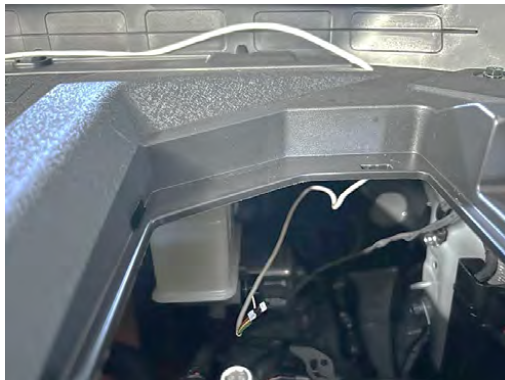
Figura 4.2.6.12: Detalle de paso del cable bajo el embellecedor de motor
