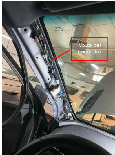
Figura 4.2.4.3: Recorrido del mazo del taxímetro bajando por el pilar A
