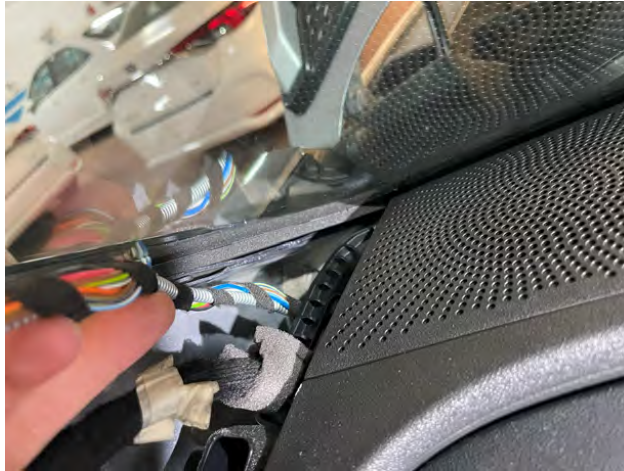
Figura 4.2.4.4: Entrada del mazo del taxímetro por el lateral del salpicadero
