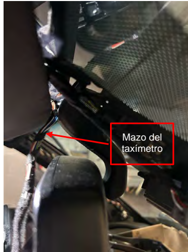
Figura 4.2.4.2: Recorrido del mazo del taxímetro hacia el interior del techo
