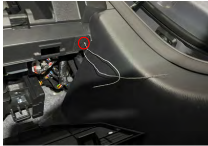
Figuras 3.3.3.1: Posición de los taladros para el precinto del concesionario
