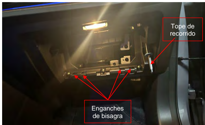
Figura 3.3.1.8: Fijaciones de la guantera
