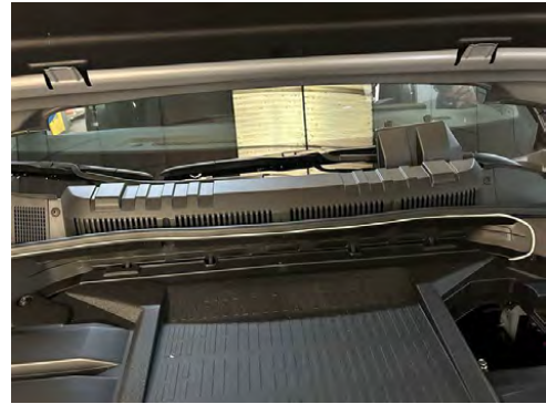
Figura 4.2.6.11: Cable bajo la goma del capó
