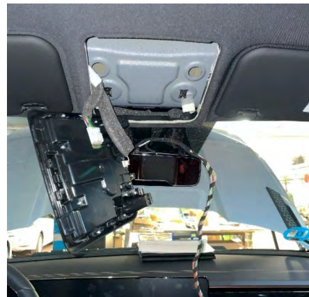
Figura 4.2.6.4: Plafón de techo desmontado
