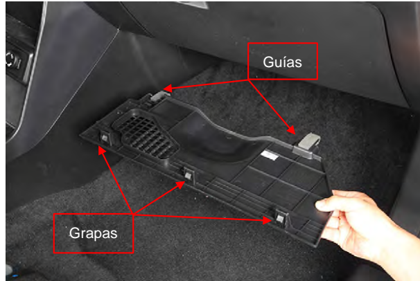
Figura 3.3.1.9: Tapa inferior de la guantera
