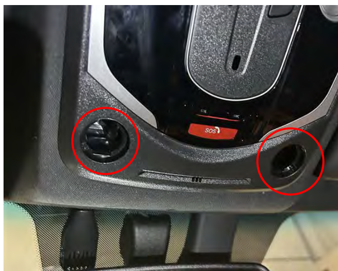
Figura 4.2.6.3: Ubicación de los tornillos de fijación del plafón de techo.
