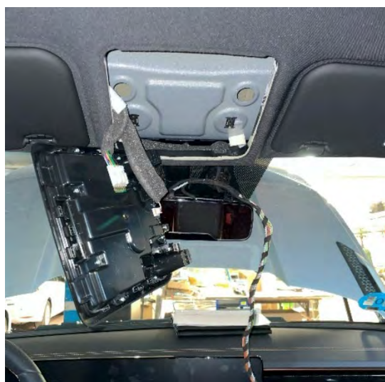
Figura 4.2.6.4: Plafón de techo desmontado
