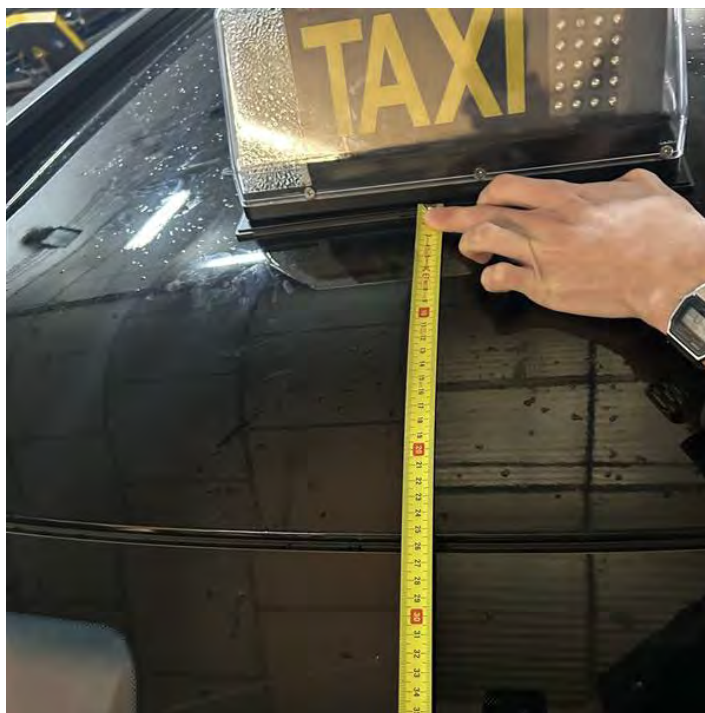
Figura 4.2.6.2: Módulo tarifario a 250 mm del borde del parabrisas
