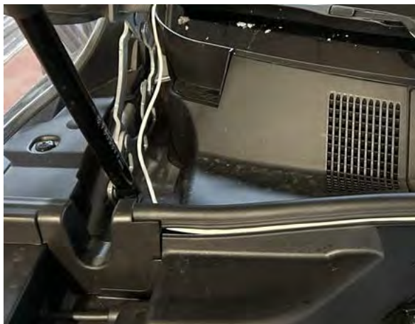
Figura 4.2.6.10: Cable por el torpedó
