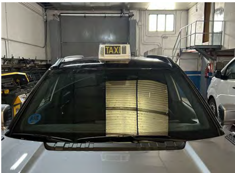
Figura 4.2.6.1: Módulo tarifario centrado sobre el techo
