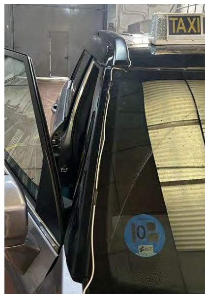
Figura 4.2.6.9: Cable por el vierteaguas
