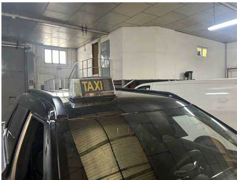
Figura 4.2.6.7: Módulo tarifario descentrado sobre base magnética
