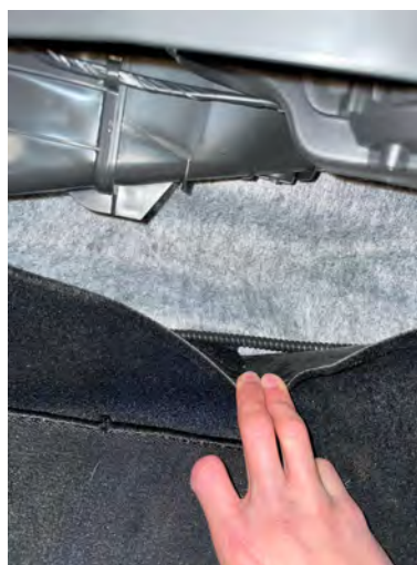
Figuras 3.3.2.2: Guiado de la manguera del cable de señal
