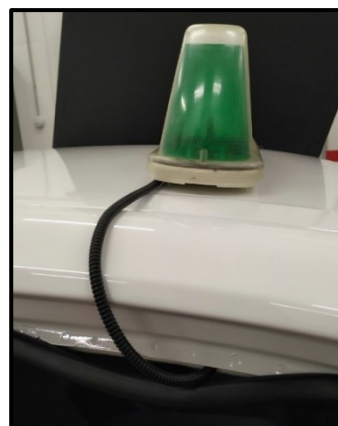
Ejemplos de recorrido del cable por el vierteaguas o por el interior de la puerta
