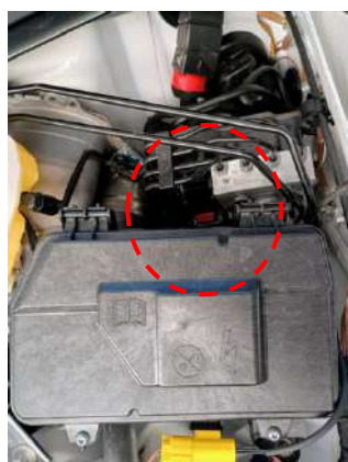
Ubicación de la unidad ESP en el compartimento motor
