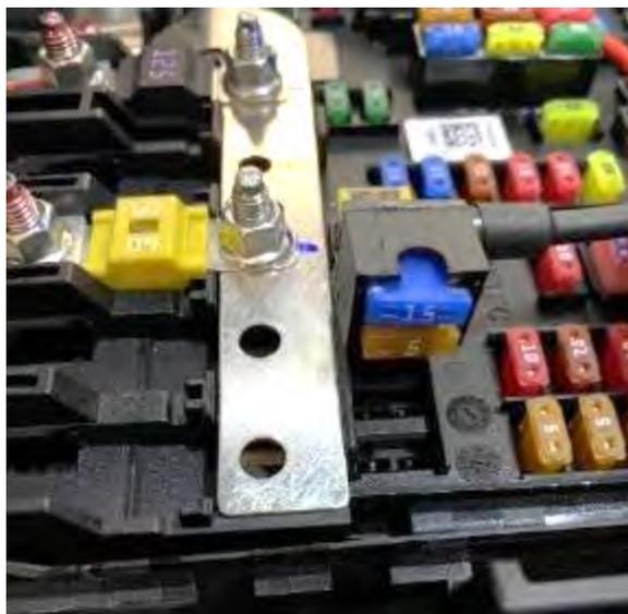
**Fig. 3.4.1.2.5.** Vista del portafusibles para señal de positivo bajo llave
