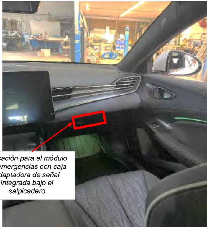
*Ubicación para el módulo de emergencias con caja adaptadora de señal integrada bajo el salpicadero*
