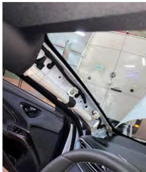
*Fig. 5.3.9 y 5.3.10. Desguarnecido del marco del pilar del parabrisas.*
