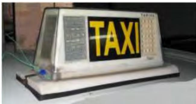
**Fig. 5.5.11.** Vista de un módulo luminoso precintado
