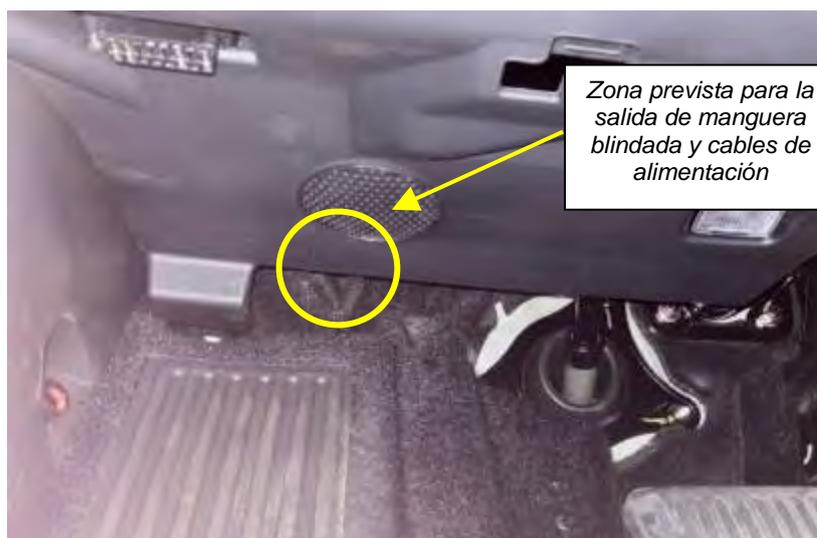
**Fig. 3.4.1.3.3.** Salida de manguera blindada y cables de alimentación
