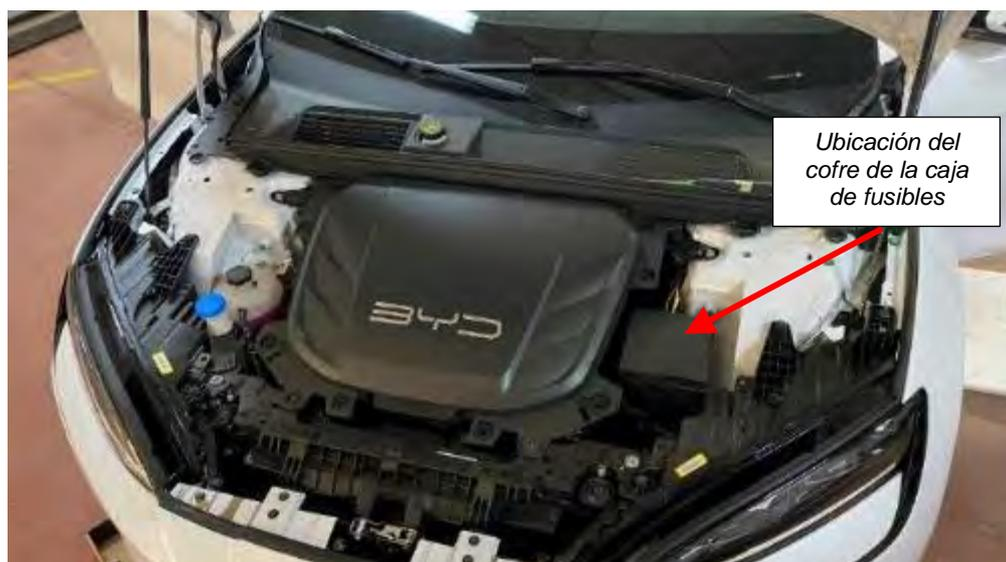
**Fig. 3.4.1.5.** Ubicación de la caja de fusibles.
