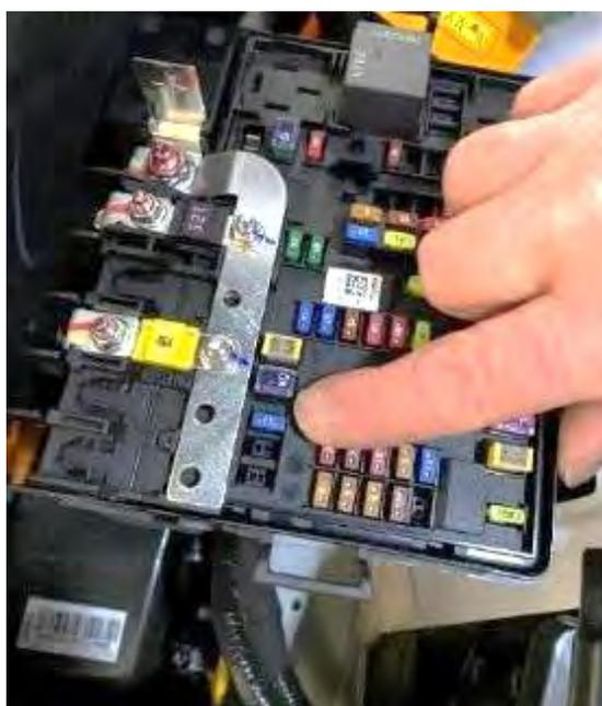
**Fig. 3.4.1.2.4.** Identificación fusible batería para señal de positivo bajo llave
