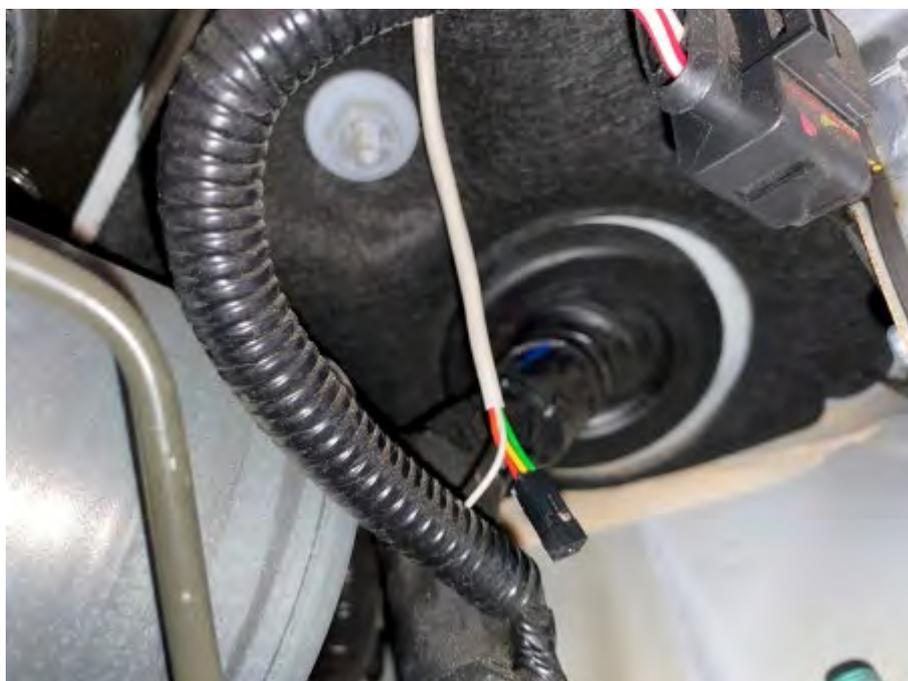
*Fig. 5.5.7. Vista del pasamuros y de la terminación del cable del módulo.*
