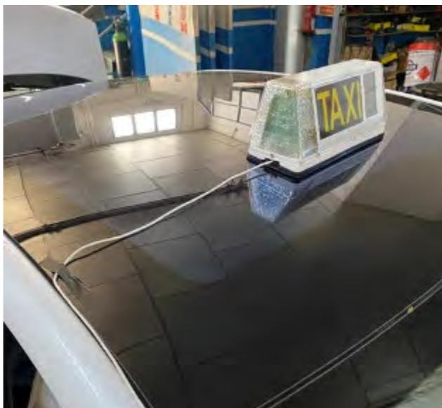
**Fig. 5.5.4.** Recorrido del cable del módulo (centrado) hasta el vierteaguas lateral
