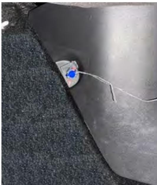
**Fig. 3.4.1.3.5.** Vista final del precintado del guarnecido del marco de la puerta
