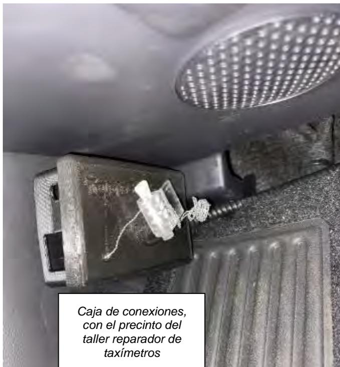
**Fig. 5.2.1.** Vista de la caja de conexiones (precintada)
