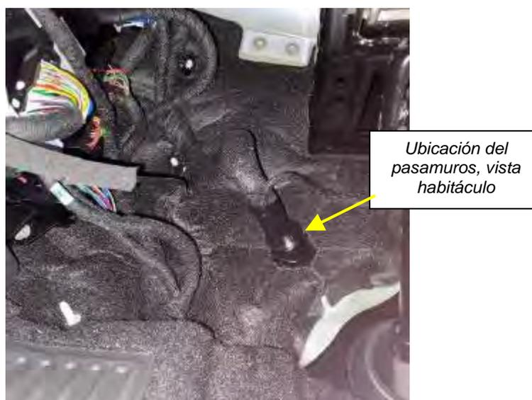
*Fig. 3.4.1.2.6 y 3.4.1.2.7. Vistas del pasamuros para el cable de señal de positivo bajo llave*
