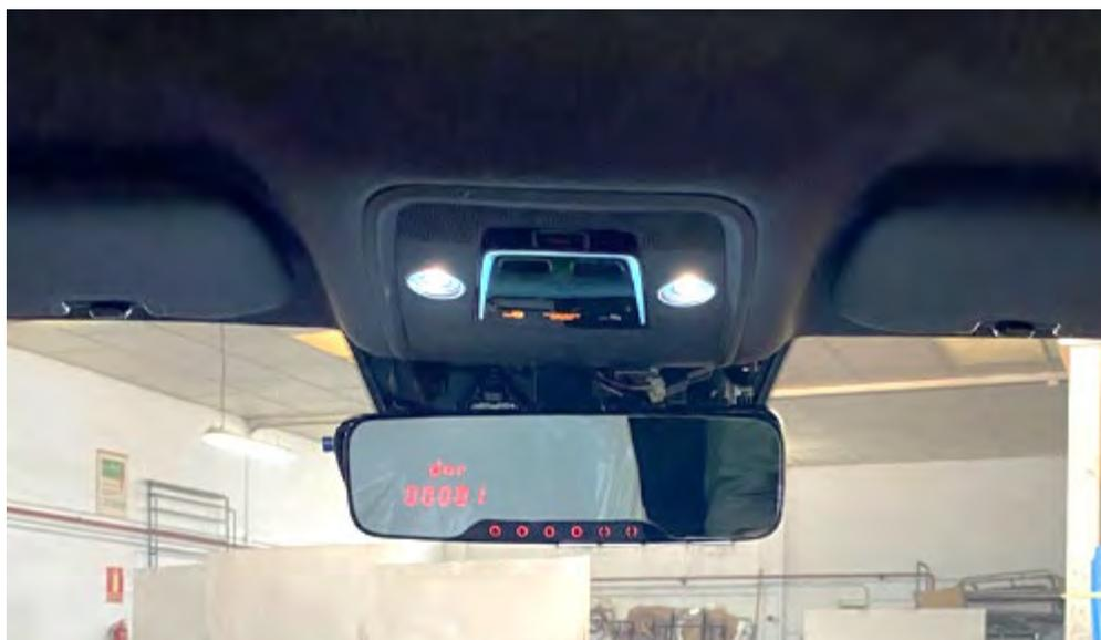
**Fig. 5.3.13.** Ejemplo de taxímetro de espejo superpuesto instalado.
