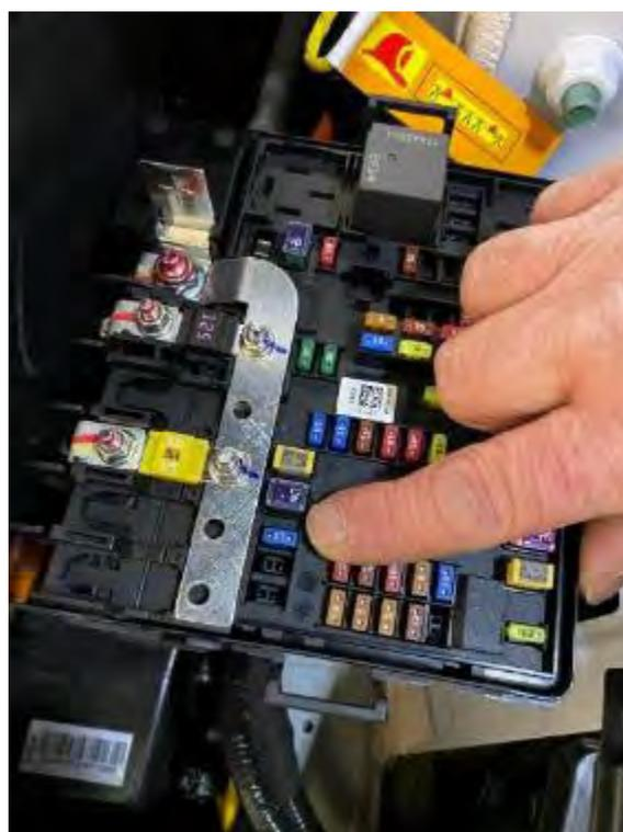
**Fig. 3.4.1.6.** Identificación del **fusible F1/46 de 15A** para toma de positivo bajo contacto
