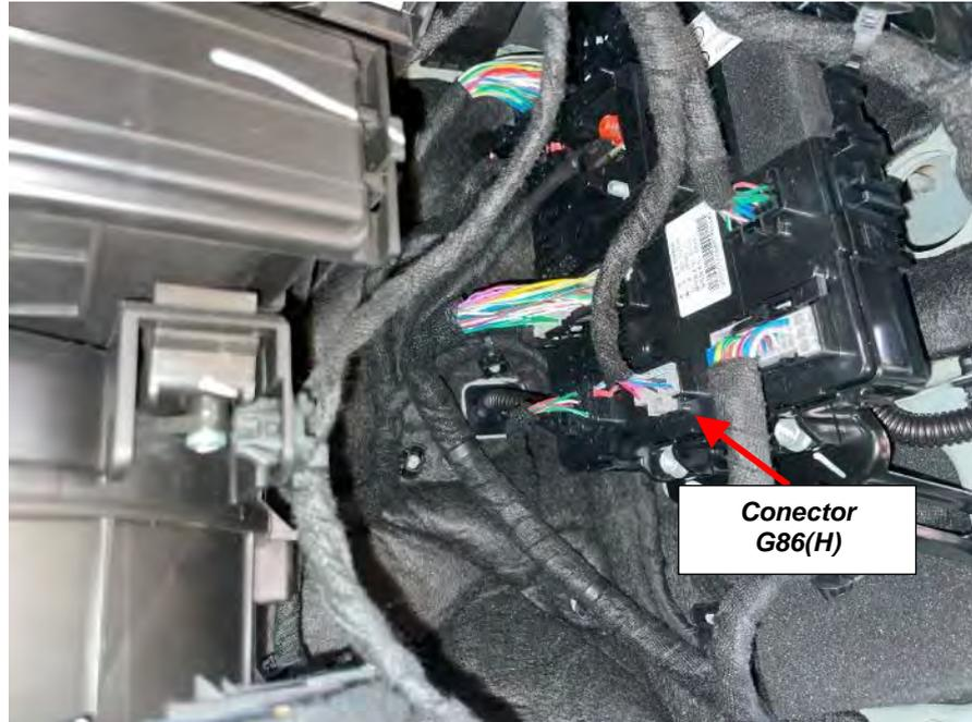
**Fig. 3.4.1.1.** Vista de la ubicación del conector G86(H) tras el salpicadero en el lado del acompañante.
