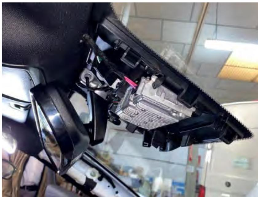
**Fig. 5.3.4.** Vista recubrimiento del soporte del retrovisor desmontado.
