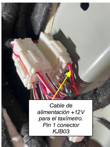
**Fig. 3.4.1.2.1.** Cable de toma de corriente para alimentación del taxímetro.
