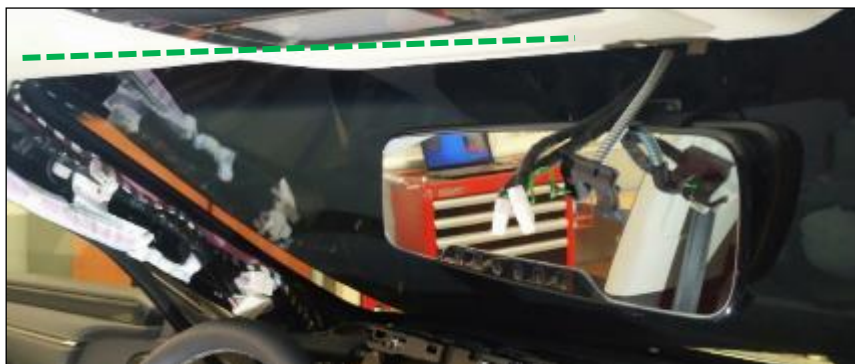
Recorrido del cable del módulo tarifario
