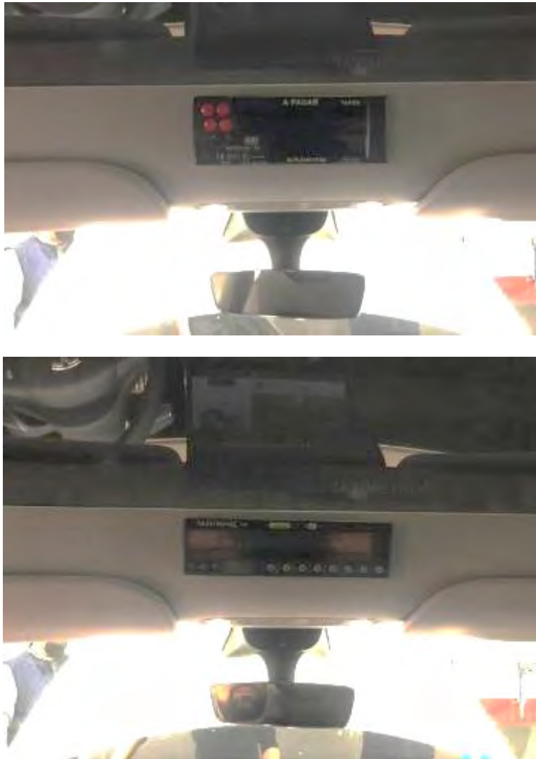
Vistas de taxímetros de consola con soporte interior, en la ubicación prevista en el techo.
