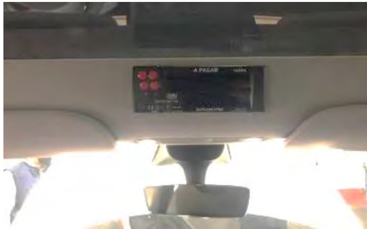
Fig. 9. Vista de un taxímetro de consola en la ubicación prevista en el techo.
