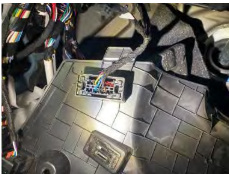
Esquemas de la ubicación y desmontaje del guarnecido para acceso al conector X181 en vehículos anteriores a 2025
