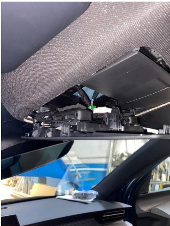
Para el montaje del conjunto luminoso es necesario practicar los orificios en el techo del vehículo para el paso del cable y de las sujeciones del mismo, generalmente dos para atornillar el módulo, de  $\varnothing 7$  mm, y el otro centrado para la conducción eléctrica, de  $\varnothing 16$  mm)
