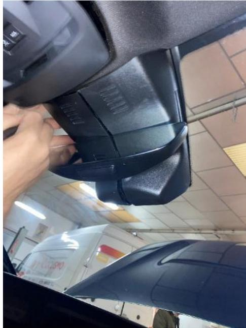
En caso de reemplazar completamente al retrovisor original, se desmontará también el conjunto del guarnecido del parabrisas.
