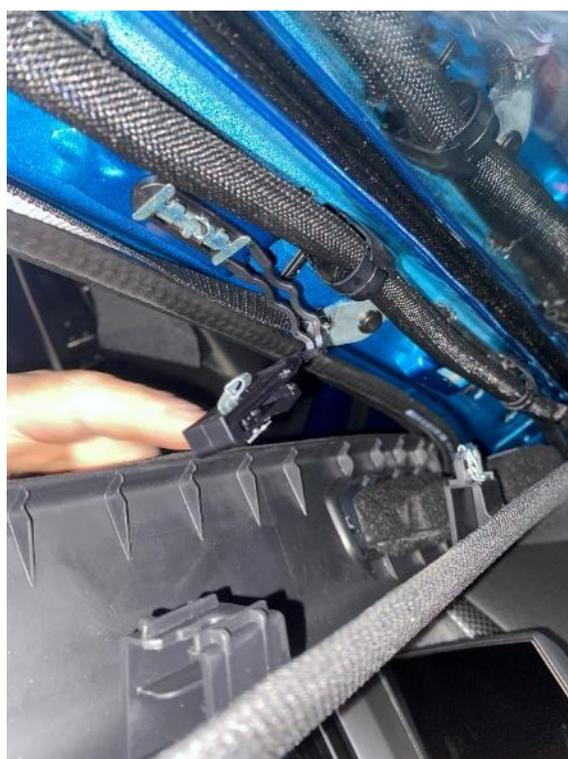
El recorrido de la manguera blindada pasará por el salpicadero hacia el pilar A por el hueco dispuesto para tal efecto, una vez desmontado el guarnecido del pilar A.
