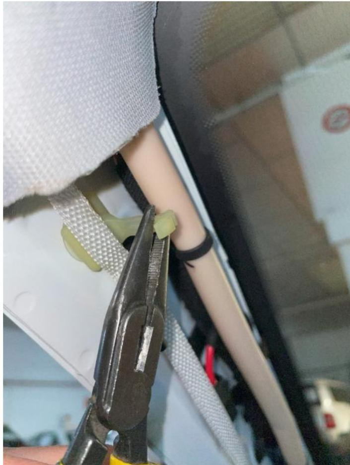
*Figura 4.2.4.4. Detalle de la grapa superior del panel del pilar A*
