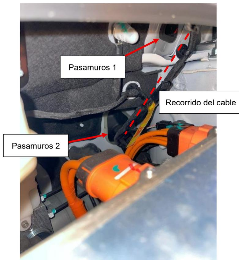
Figura 4.2.6.17. Recorrido del cable del módulo tarifario por el hueco motor
