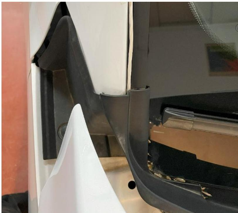
*Figura 4.2.6.14. Entrada del cable del módulo por debajo del torpedo*
