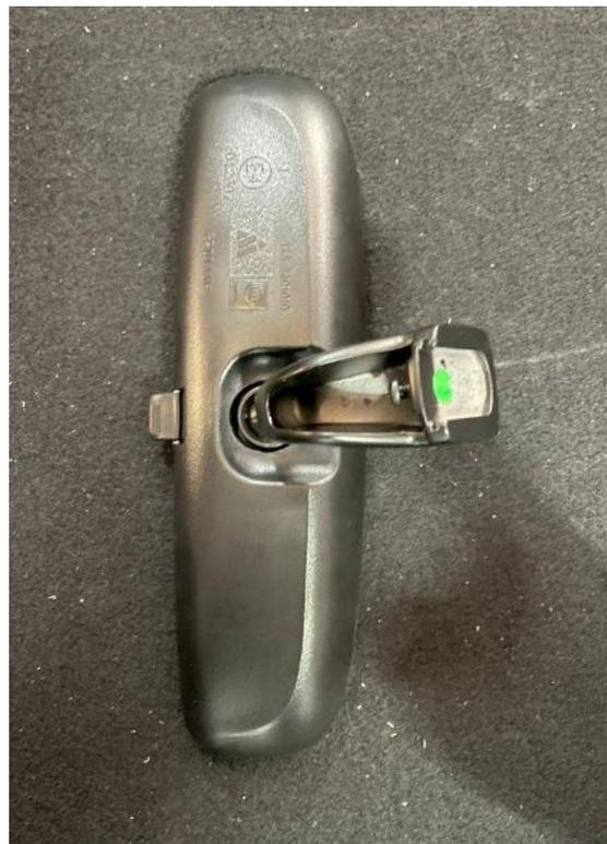
*Figuras 4.2.6.4. y 4.2.6.5. Detalle del sistema de anclaje del espejo original*
