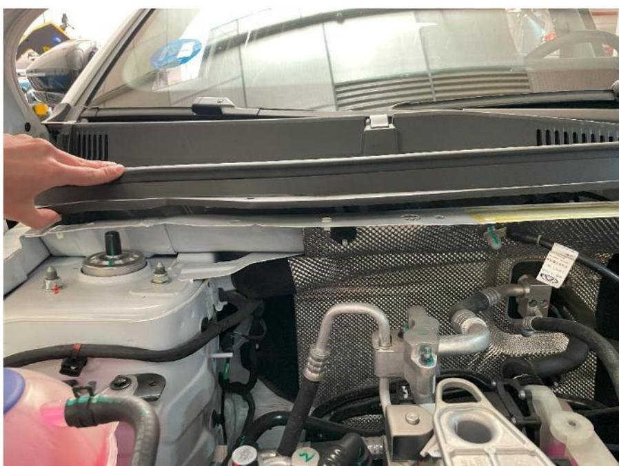
*Figura 4.2.6.15. Torpedo ligeramente levantado para la colocación del cable del módulo*
