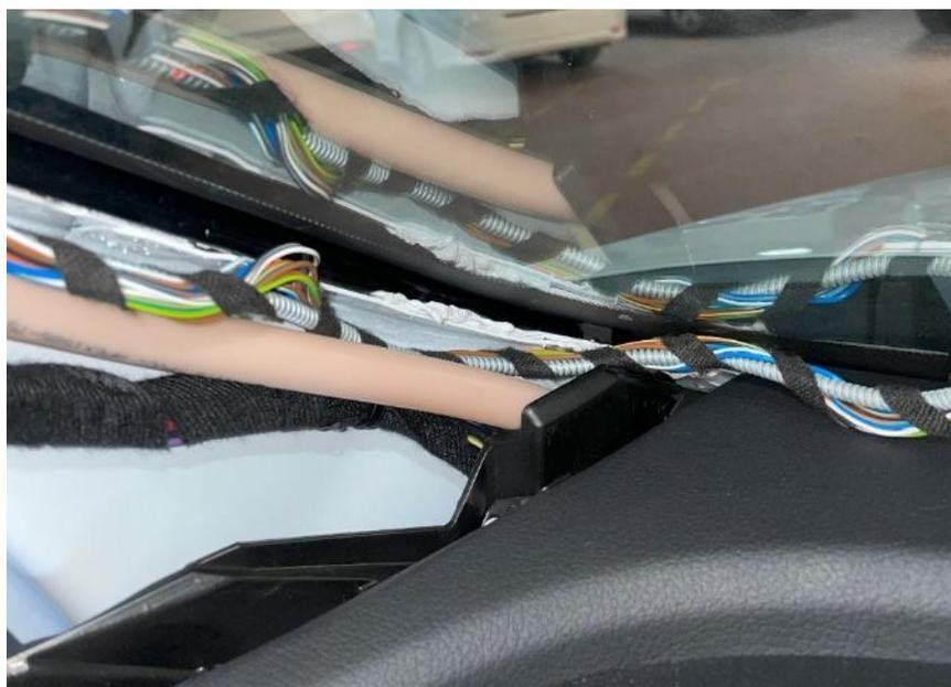
*Figura 4.2.4.7. Entrada del mazo del taxímetro por el lateral del salpicadero*
