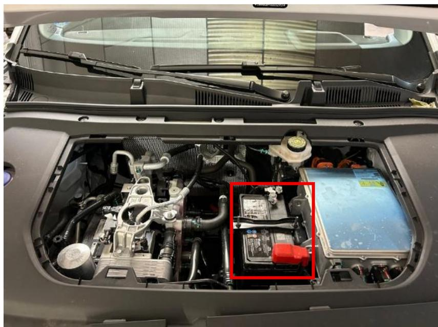
*Figura 3.3.1.3. Localización de la batería de 12V*
