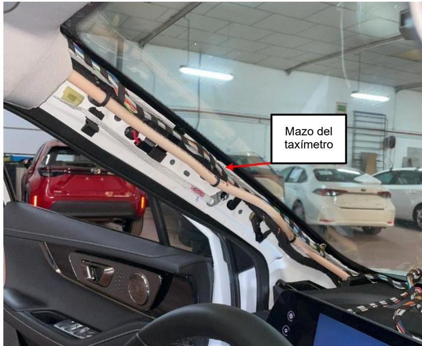
*Figura 4.2.4.6. Recorrido del mazo del taxímetro bajando por el pilar A*
