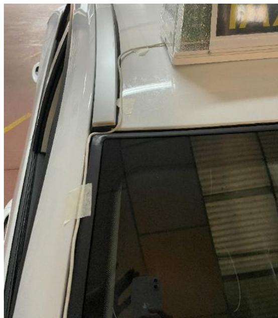
*Figura 4.2.6.13. Recorrido del cable del módulo por el vierteaguas*
