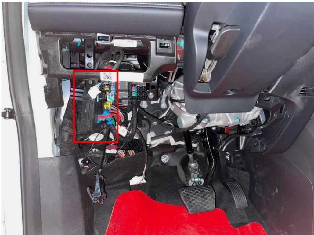
*Figuras 3.3.1.1. Localización del Body Control Module (BDM)*
