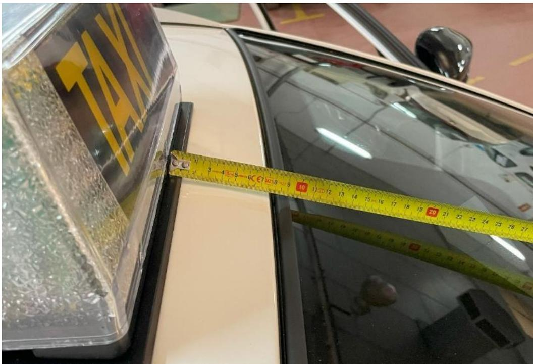
*Figura 4.2.6.2. Módulo tarifario a 80 mm del borde del parabrisas*
