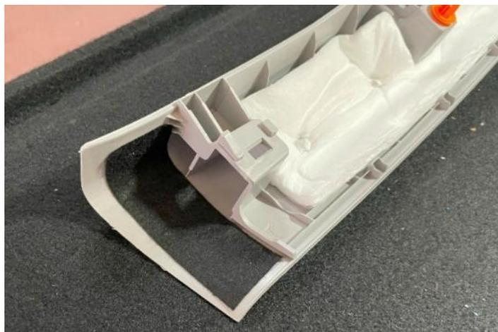
*Figura 4.2.4.5. Detalle del alojamiento de la grapa superior del panel del pilar A*
