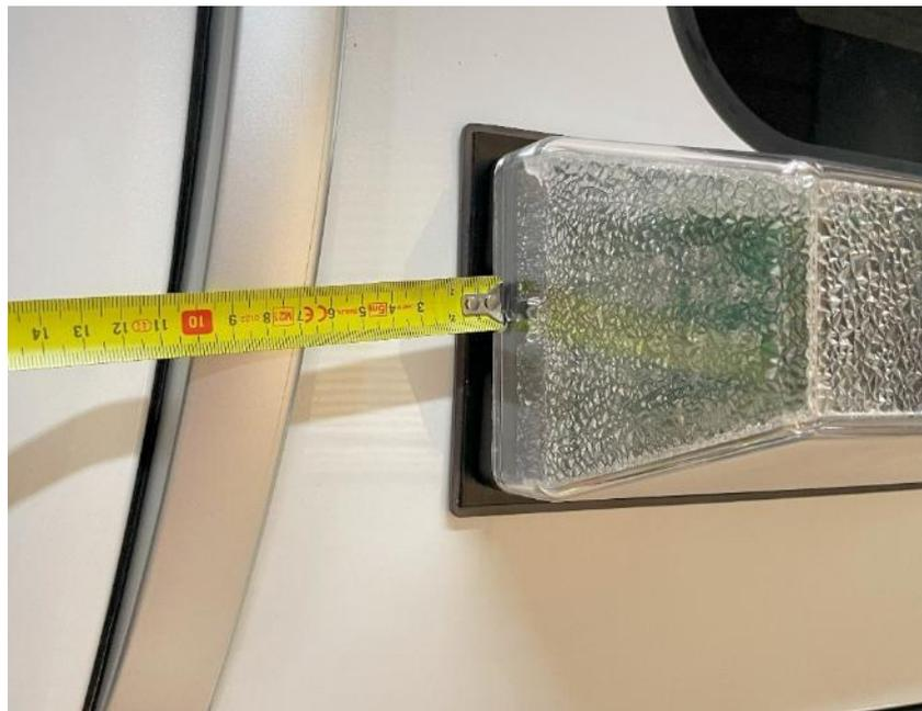
*Figura 4.2.6.11. Posicionamiento del módulo tarifario desplazado a 70 mm de la barra*
