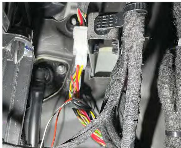
Figura 3.3.2.8. Empalmes de la señal CAN Bus
