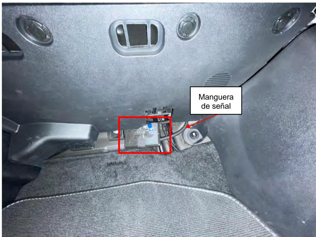
Figura 4.1.1.1: Ubicación prevista para la caja de conexiones
