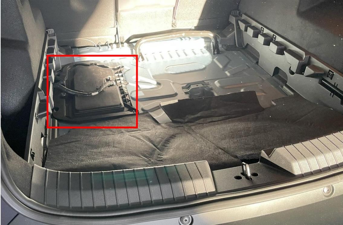
*Figura 3.3.1.3. Vista de la tapa de la batería*
