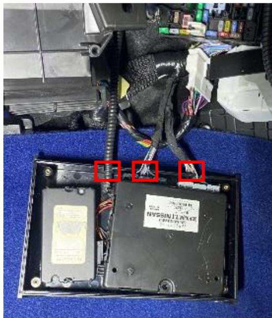
Figura 3.3.3.2. Detalle de rebajes en la caja contenedora
