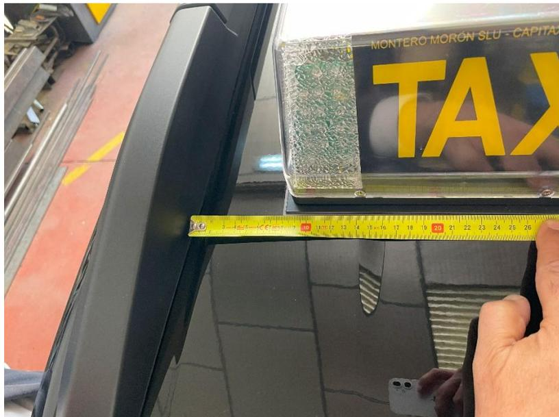
*Figura 4.2.6.7. Posicionamiento del módulo tarifario desplazado*
