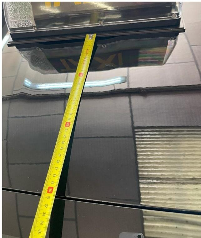
Figura 4.2.6.2. Módulo tarifario a 300 mm del borde del parabrisas
