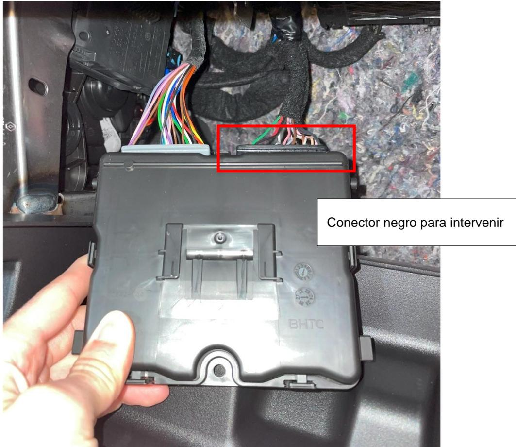
Figura 3.3.1.7. Calculador de climatización
