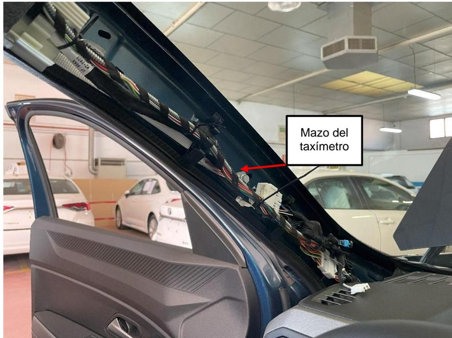
*Figura 4.2.4.4. Recorrido del mazo del taxímetro bajando por el pilar A*
