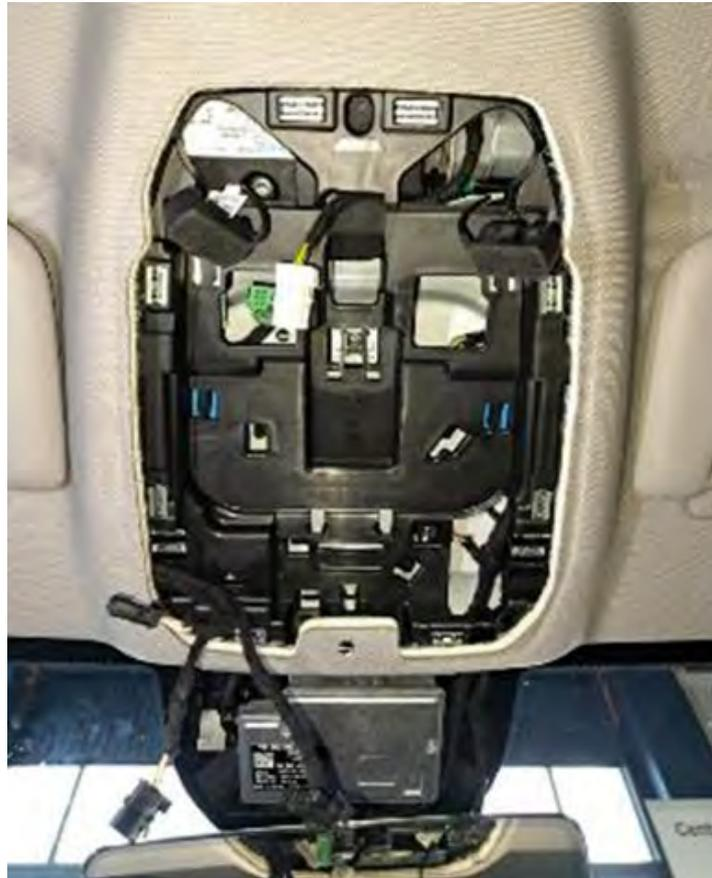
Para el montaje del conjunto luminoso es necesario practicar los orificios en el techo del vehículo, para el paso del cable y de las sujeciones del mismo, generalmente dos para atornillar el módulo, de  $\varnothing 7$  mm, y el otro centrado para la conducción eléctrica, de  $\varnothing 16$  mm)
