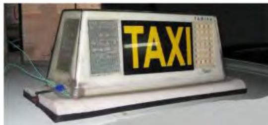
Se deberá de precintarse la conexión del módulo una vez instalado.
