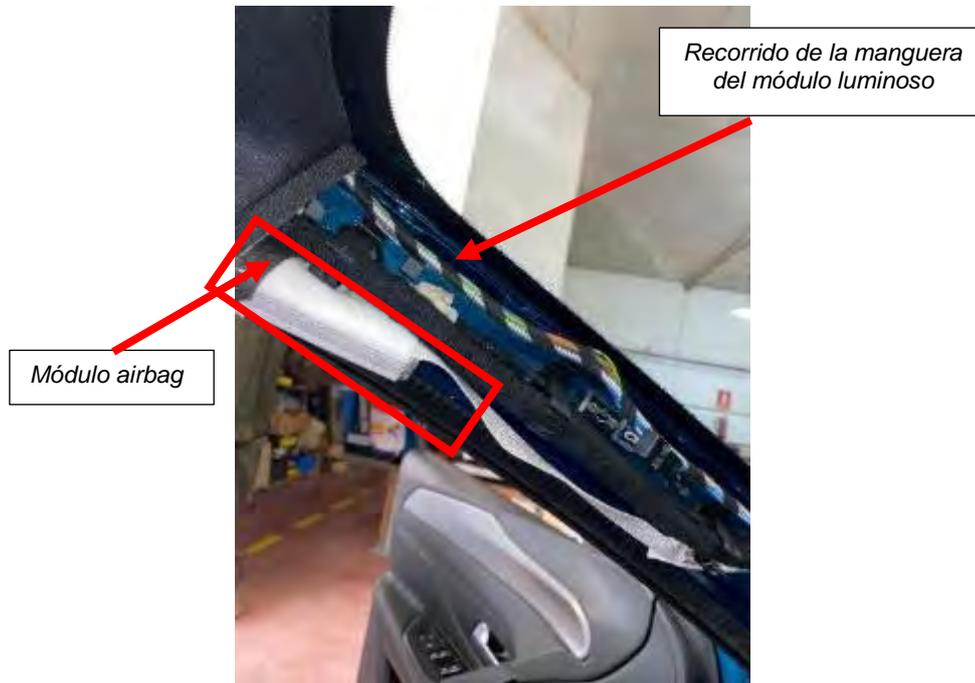
**IMPORTANTE:** Pasar siempre el cable del módulo luminoso por la parte superior del módulo de airbag de cortina en el pilar A (conductor).
