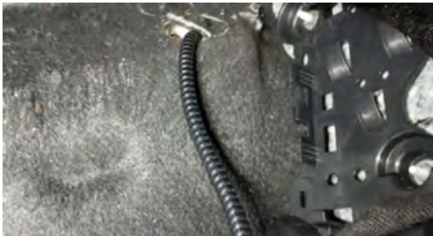
Se llevará el extremo de la manguera blindada por la moqueta hasta la parte izquierda del salpicadero, junto a la VSM donde se terminará de realizar las conexiones para la alimentación eléctrica.
