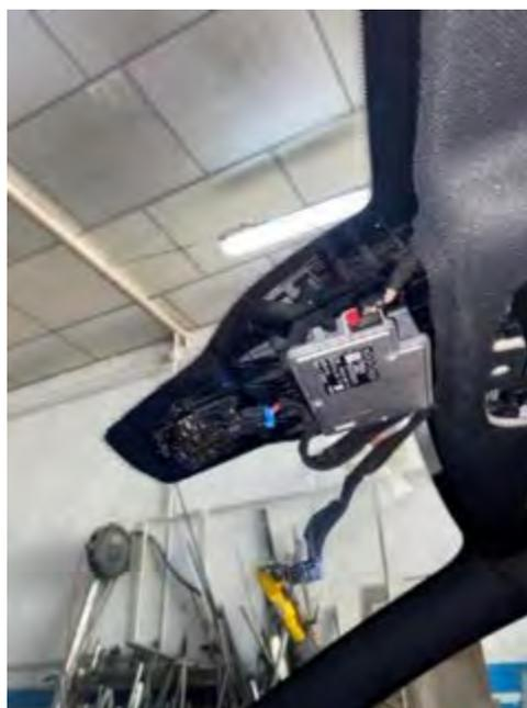
Para el paso de los cables del taxímetro de espejo, se tiene que retirar también el guarnecido interior del pilar A del conductor anclado mediante grapas.
