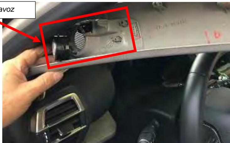
El recorrido de la manguera blindada pasará por el salpicadero hacia el pilar A por el hueco dispuesto para tal efecto, una vez desmontado el guarnecido del pilar A.
