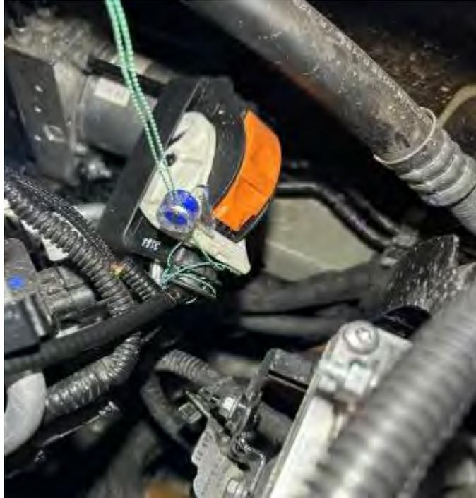
Volveremos a restituir el conector eléctrico en su ubicación original, cerrando la brida, volviendo a tensar los extremos del alambre, enrasando el precinto plástico y a realizar el precintado definitivo.
