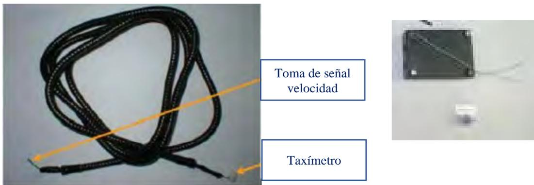
La manguera lleva en su interior 1 cable de sección 0,25 mm. Para las instalaciones en vehículos de la marca PEUGEOT, solo se utiliza el cable que es el de señal, para la caja adaptadora.
