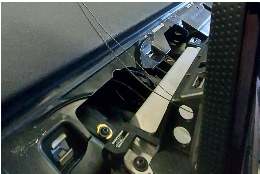
Figura 14. Detalle de precintado.
