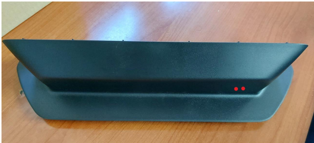
Figura 13. Detalle de la zona a taladrar.
