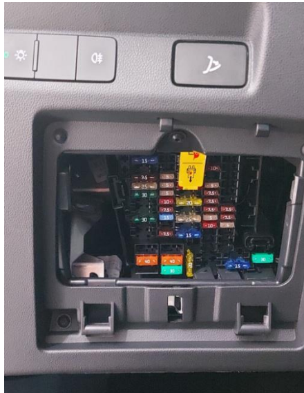
Figura 2. Caja de fusibles.
