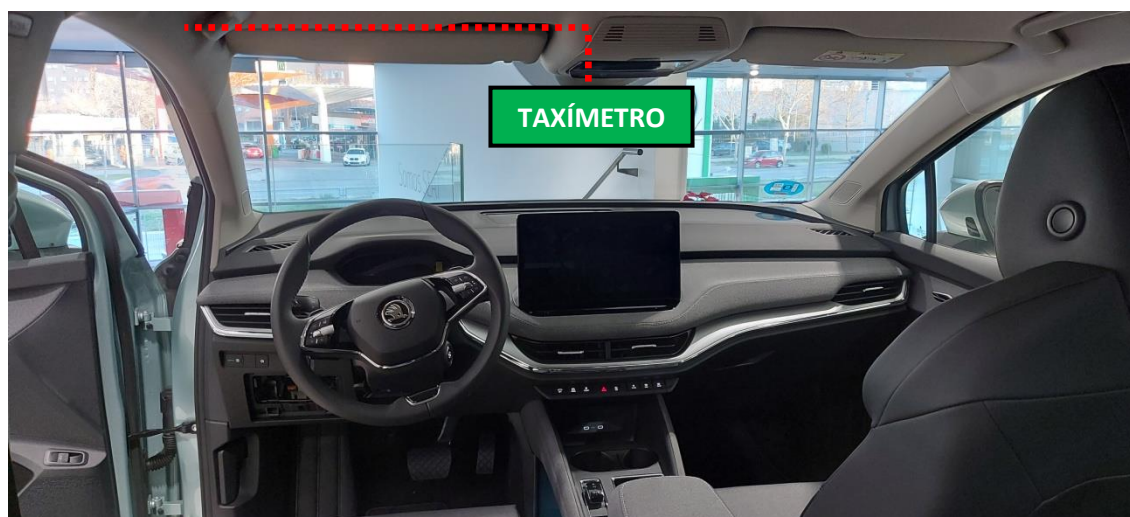
Figura 20. Trazado del cable del módulo tarifario.
