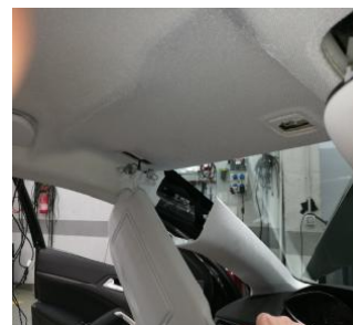
Se desmonta el guarnecido lateral
