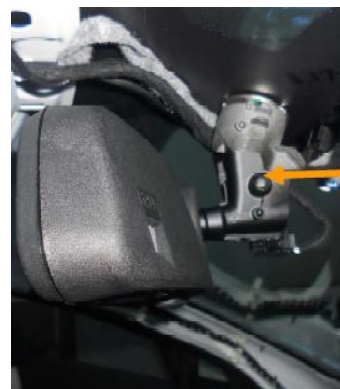
Montar el nuevo espejo con taxímetro
