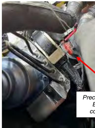
*Precinto del conector de la BCM2 con alambre corrugado y roto-seal*
