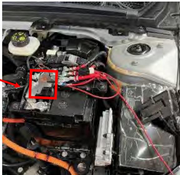
Para la toma de alimentación se utilizarán dos cables estándar (color rojo y negro) de sección 1,5 mm, del tipo que se muestra. Longitud de 50 cm para ambos cables:
