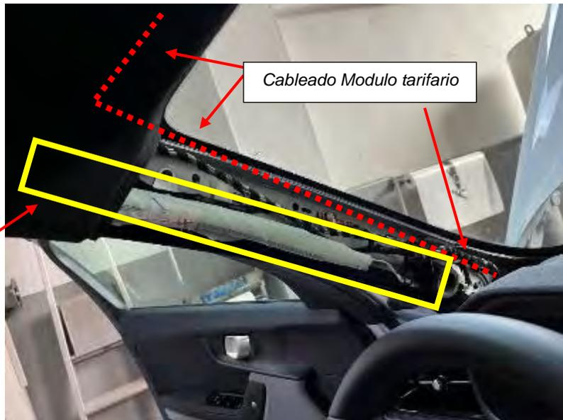
**IMPORTANTE:** El mazo de conexiones del Módulo tarifario deberá discurrir por el interior de guarnecido del pilar A siempre por encima del módulo de airbag lateral y asegurando la no interferencia del mismo con la zona de despliegue del airbag.
