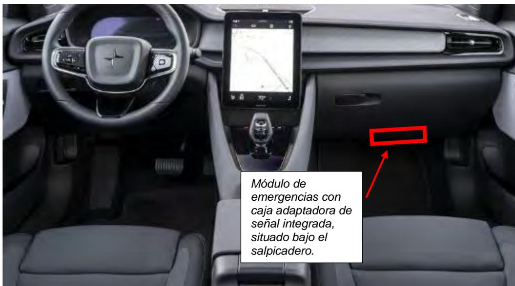
Será necesario el desmontaje del guarnecido del módulo central y la guantera, instrucciones adjuntas a este documento.
