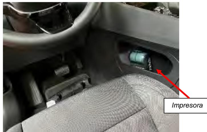
El cable de conexión de la impresora discurrirá por el interior de la zona inferior del volante, sobre los pedales, hasta el guarnecido del módulo central.
