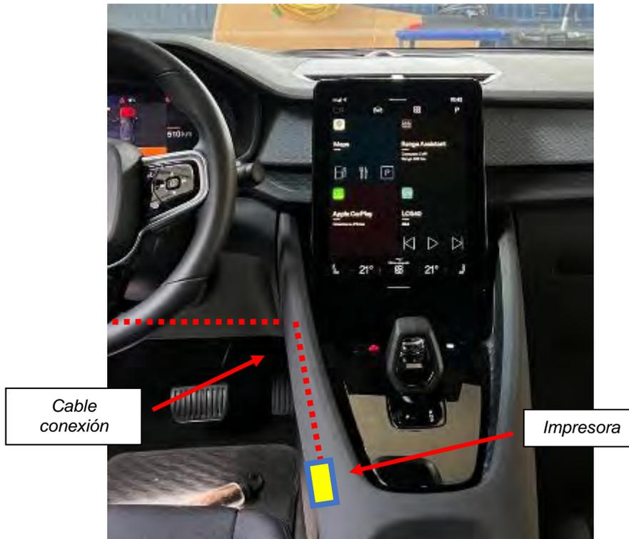
Para el paso del cableado de conexión de la impresora hasta cada una de sus posibles ubicaciones, se practicará un taladro en las siguientes ubicaciones
