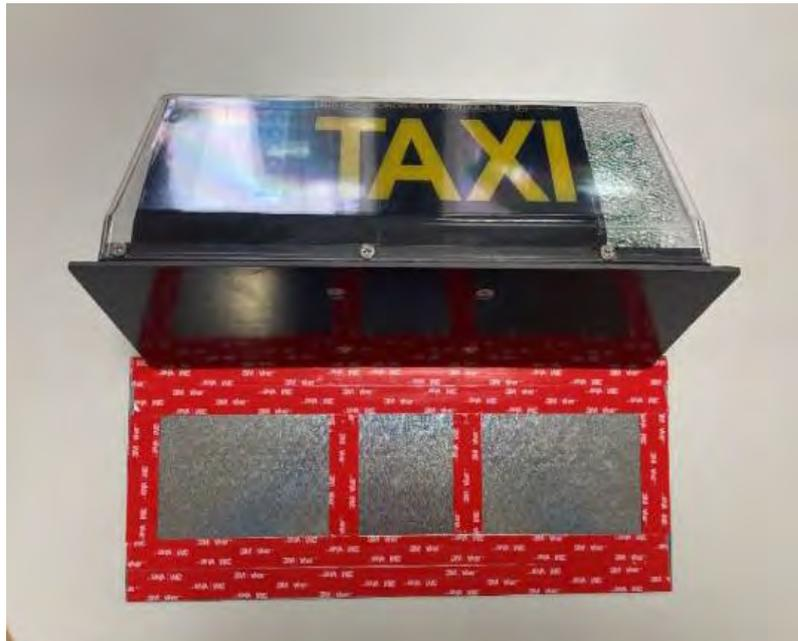
*Vista de un módulo imantado y preparación del adhesivo en pletina metálica*
