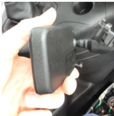
Desmontar el espejo de origen
