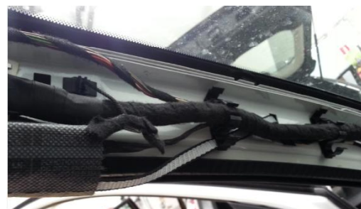
Encaminado del mazo hasta la BSI
