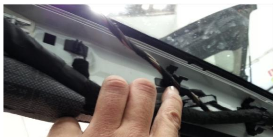
Encaminado del mazo hasta la BSI
