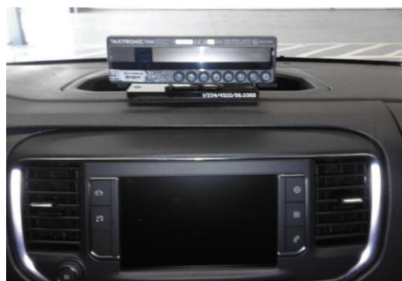
Montaje sobre el borde de la guantera
