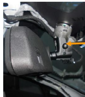
Montar el nuevo espejo con taxímetro
