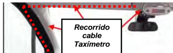
**IMPORTANTE:** El mazo de conexiones del taxímetro deberá discurrir por el interior de guarnecido del pilar A siempre por encima del módulo de airbag lateral y asegurando la no interferencia del mismo con la zona de despliegue del airbag
