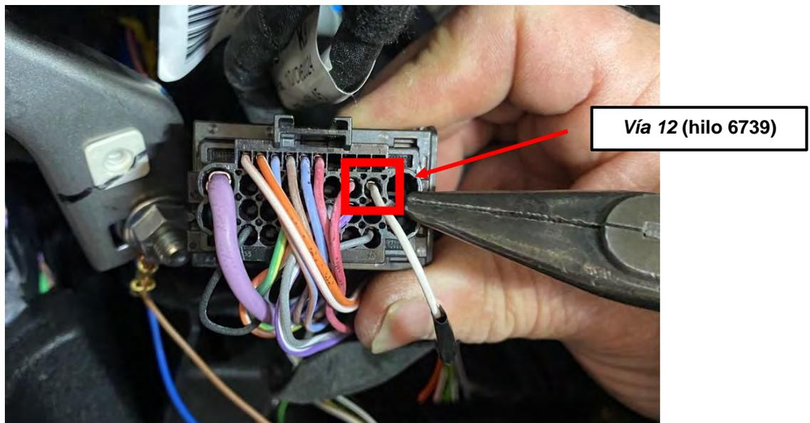
Se extraerá el conector **IC01A de 35V NR** y en la **vía 12** del conector hembra, se soldará o se conectará por el lado opuesto el **cable con manguera** por donde circulará la señal. (si se trata de un modelo anterior, se realizará sobre el mismo conector en la **vía 14**, ver indicaciones de corte en el modelo en el punto 3.2.)
