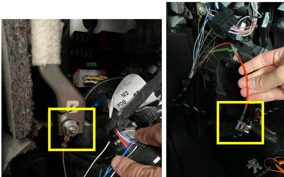
Posteriormente los cables de alimentación se enfundarán en un cable de material plástico autoextinguible y se llevarán un positivo y un negativo de batería hasta la caja adaptadora de señal situada en la zona de la VSM bajo volante lado conductor.
