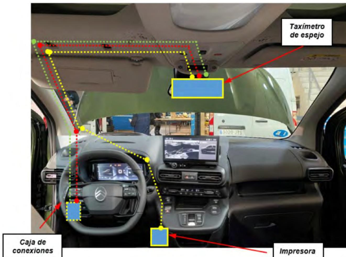
En el caso de la sustitución del espejo original (**Opción 1**), desmontamos el espejo original del soporte de tres garras que está pegado sobre la luna, sobre el cual montaremos el nuevo espejo con taxímetro incorporado.
