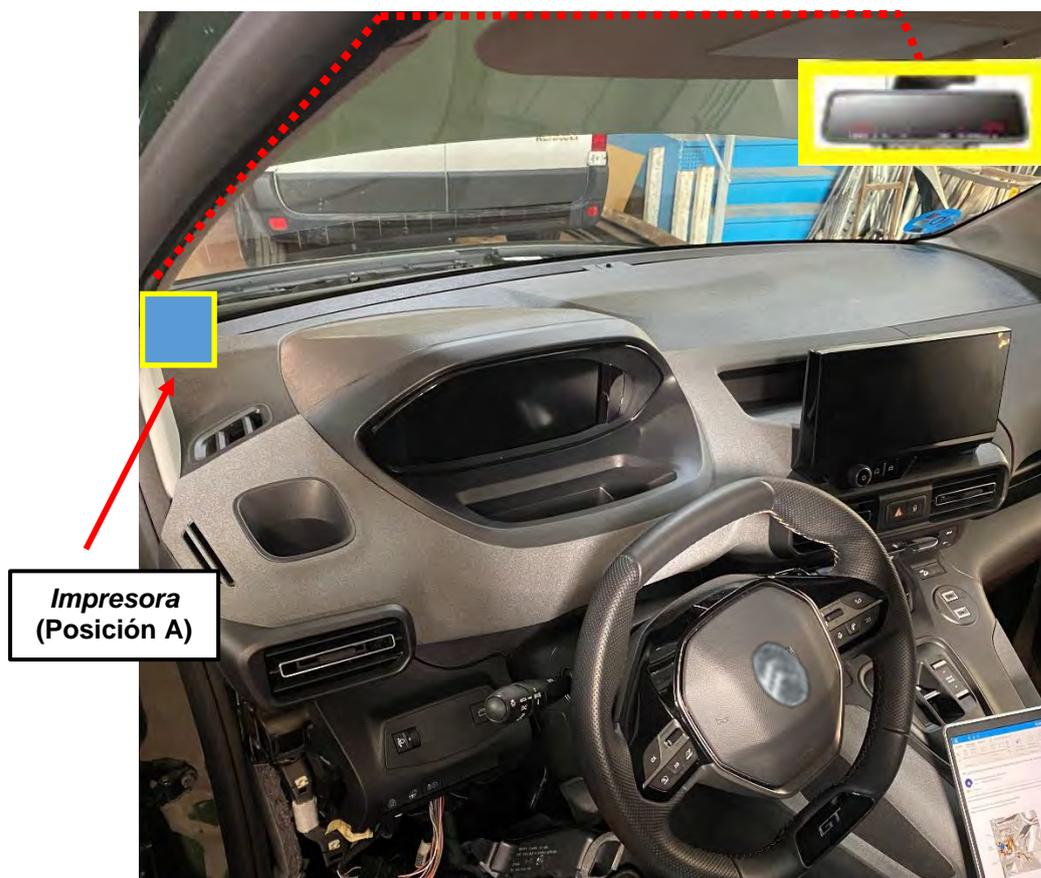
**IMPORTANTE:** El mazo de conexiones de la impresora deberá discurrir por el interior de guarnecido del pilar A siempre por encima del módulo de airbag lateral y asegurando la no interferencia de este con la zona de despliegue del airbag.
