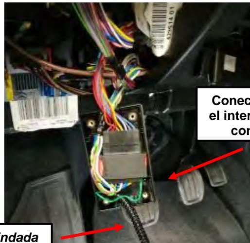
**Conector IC01A en el interior de la caja contenedora****Manguera blindada**
