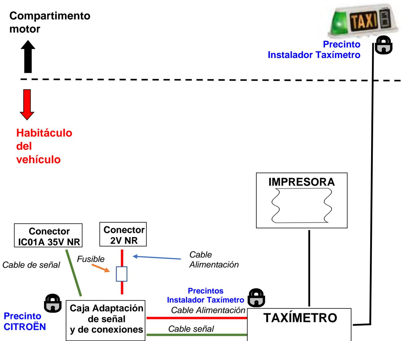
**Fusible:** Capacidad en función de los elementos a conectar, valor marcado por el fabricante del elemento o dispositivo.
