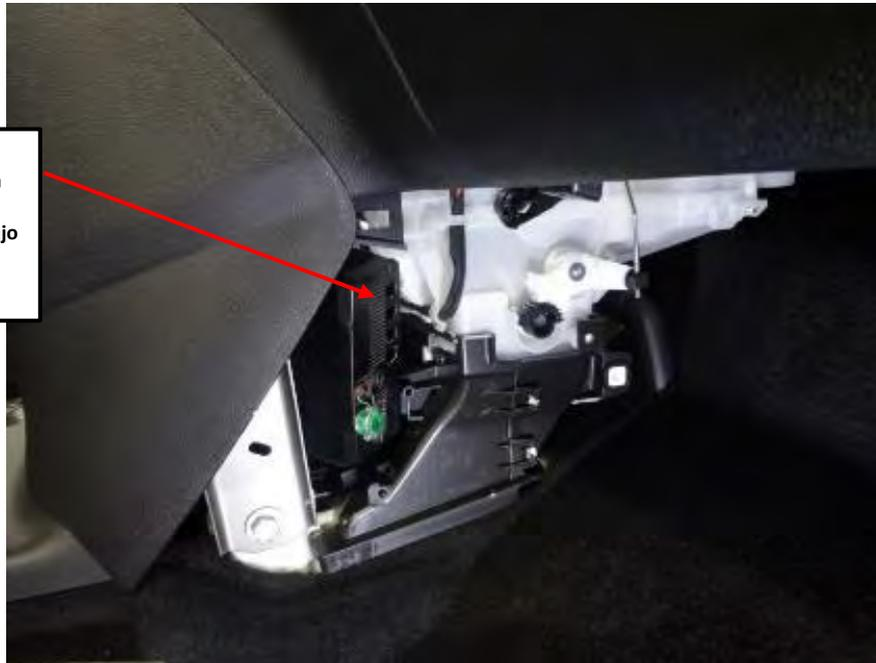
Será necesario el desmontaje de módulo derecho del salpicadero, frente al asiento de copiloto, Instrucciones de desmontaje anexas.
