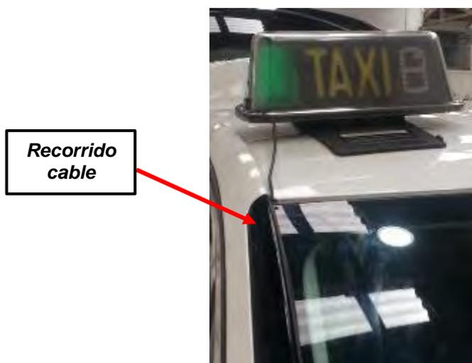
Llevaremos el cable por el interior del vierteaguas hasta el compartimento motor, ahuecamos un poco la junta que se encuentra en el final de la luna parabrisas, y guiamos el cable por el interior del guarnecido del montante parabrisas, por todo el largo de este mismo, hasta que llegamos a la zona de la batería, desde donde guiamos el cable hasta el pasamuros. Desde ahí llegaremos a la zona de la VSM.
