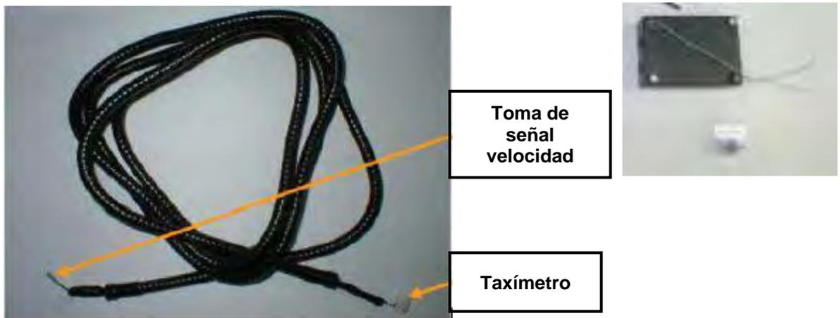
La manguera lleva en su interior 1 cable de sección 0,50 mm. Para las instalaciones en vehículos de la marca **CITROËN**, solo se utiliza el cable que es el de señal, para la caja adaptadora.
