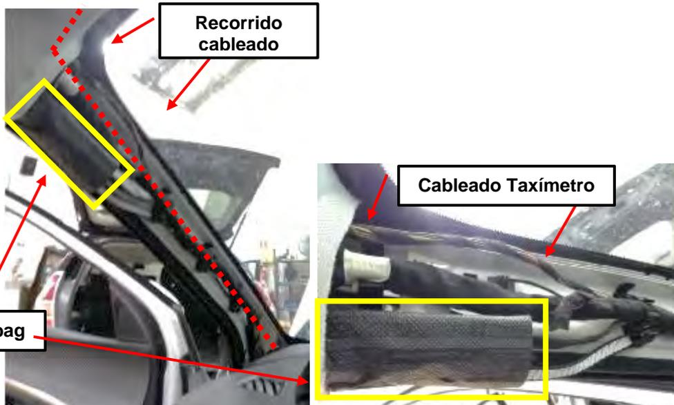
**IMPORTANTE:** El mazo de conexiones del Taxímetro deberá discurrir por el interior de guarnecido del pilar A siempre por encima del módulo de airbag lateral y asegurando la no interferencia de este con la zona de despliegue del airbag.
