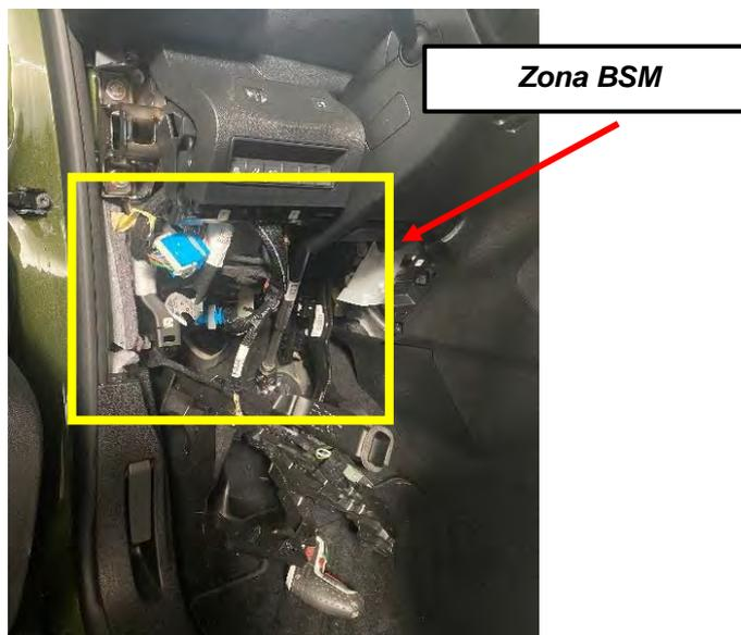
La **toma de alimentación eléctrica** de corriente continua de 12V se tomará del **conector 2V NR** del VSM, ésta proviene de la batería y se encuentra protegida por varios fusibles.
