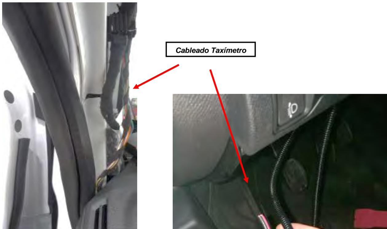
Una vez finalizada la instalación, se procederá a precintar la conexión del cable de señal con el taxímetro.
