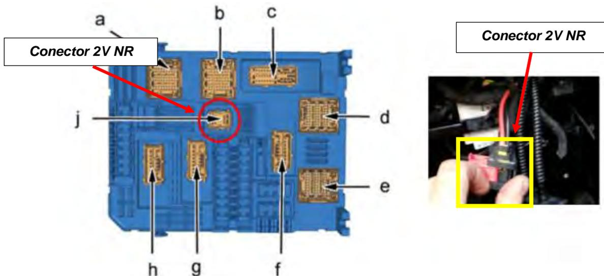
Se realizarán las conexiones a positivos con sus correspondientes fusibles aereos y un negativo de masa, protegiendo el cableado.
