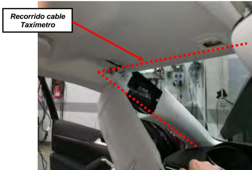
Ahora, encaminamos el mazo de conexiones del taxímetro de espejo a través del guarnecido de techo hasta el montante pilar A izquierdo.
