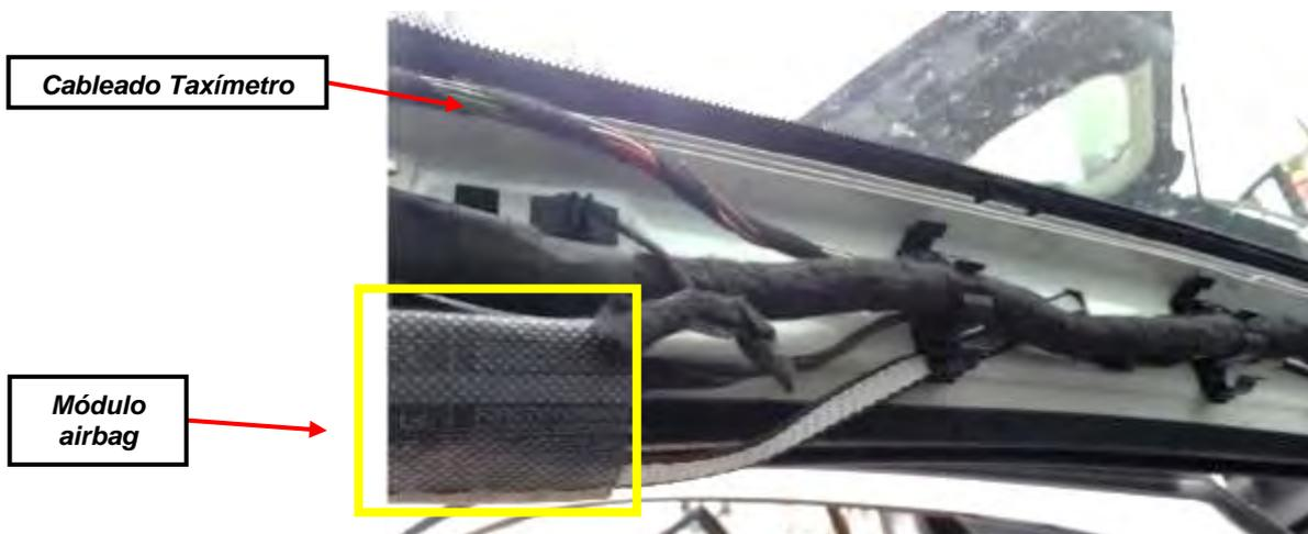
Por el interior del pilar A fijaremos el mazo de conexiones en las grapas libres que van situadas en el mismo montante. Bajaremos el cable por todo el montante hasta la junta de puerta, por el interior de ésta, meteremos el cable hasta la zona de la caja adaptadora de señal.
