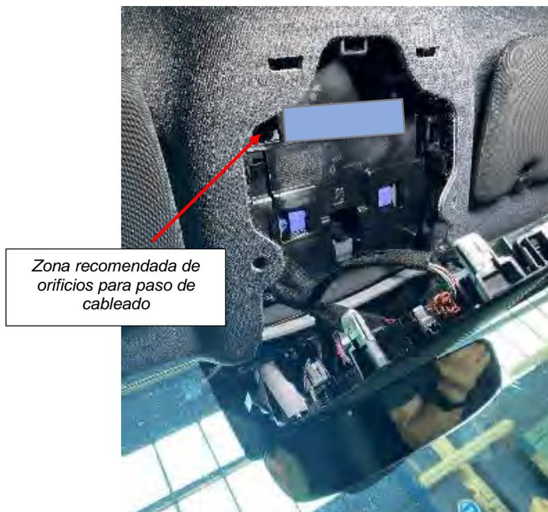
*Fig. 5.5.1.5. Zona recomdada para los taladros para el módulo tarifario atornillado.*
