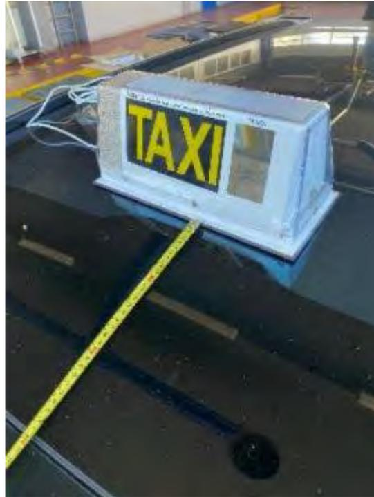
*Fig. 5.5.1.2. Distancia de separación al parabrisas.*
