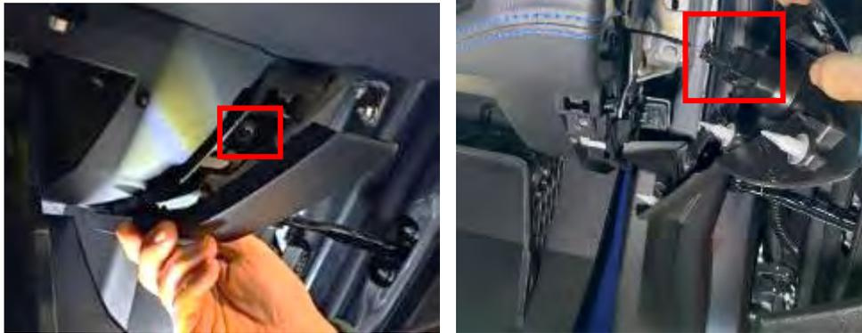
*Fig. 3.4.1.5. Detalle molduras derecha interior guantera.*
