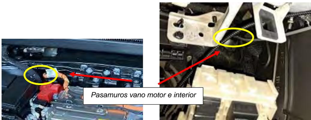
*Fig. 5.5.2.7. Vista vano motor e interior del pasamuros.*
