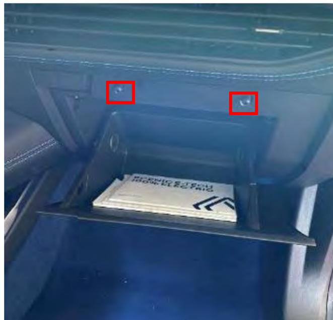
*Fig. 3.4.1.4. Detalle tornillos marco interior guantera.*
