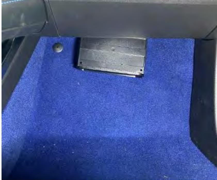
*Fig. 3.4.1.2.6. Detalle emplazamiento caja contenedora precintada e instalada con velcro.*
