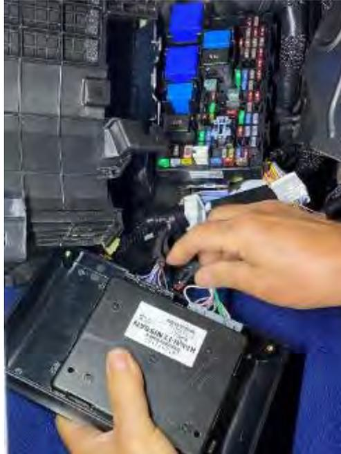
*Fig.3.4.1.2.1. Caja contenedora de calculador de Climatización (órgano 419).*
