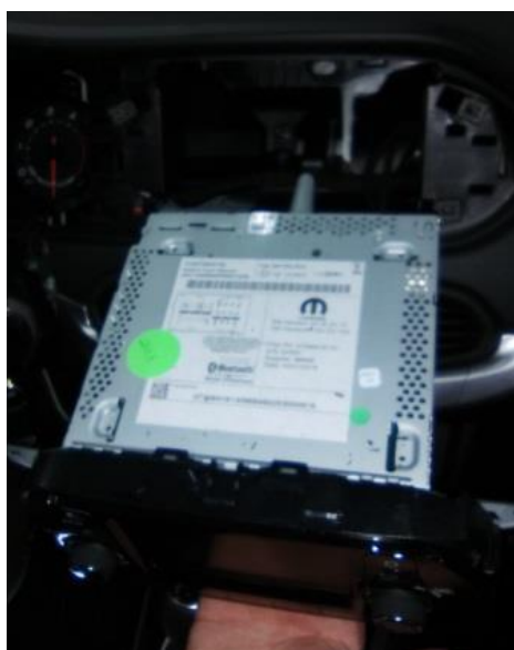
Desconectar la conexión de Antena y conexiones eléctricas (3a y 3b)
