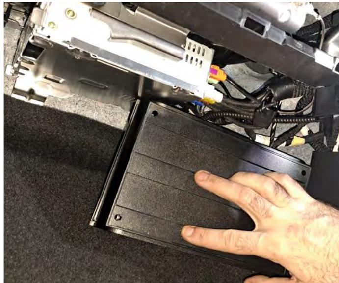
**Fig.2.2.5.** Detalle emplazamiento caja contenedora con manguera blindada.
