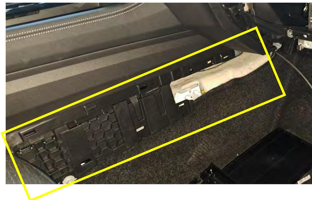
*Fig. 2.2. Tapa lateral derecha del módulo central*
