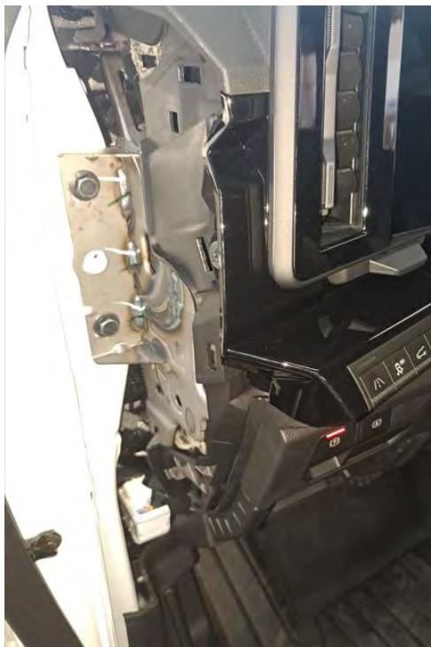
*Fig. 2.2. Detalle tornillos lateral caja de fusibles.*
