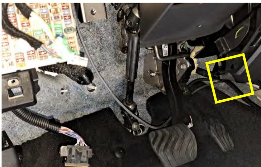
*Fig. 2.3. Zona del paso de cables lado del conductor.*
