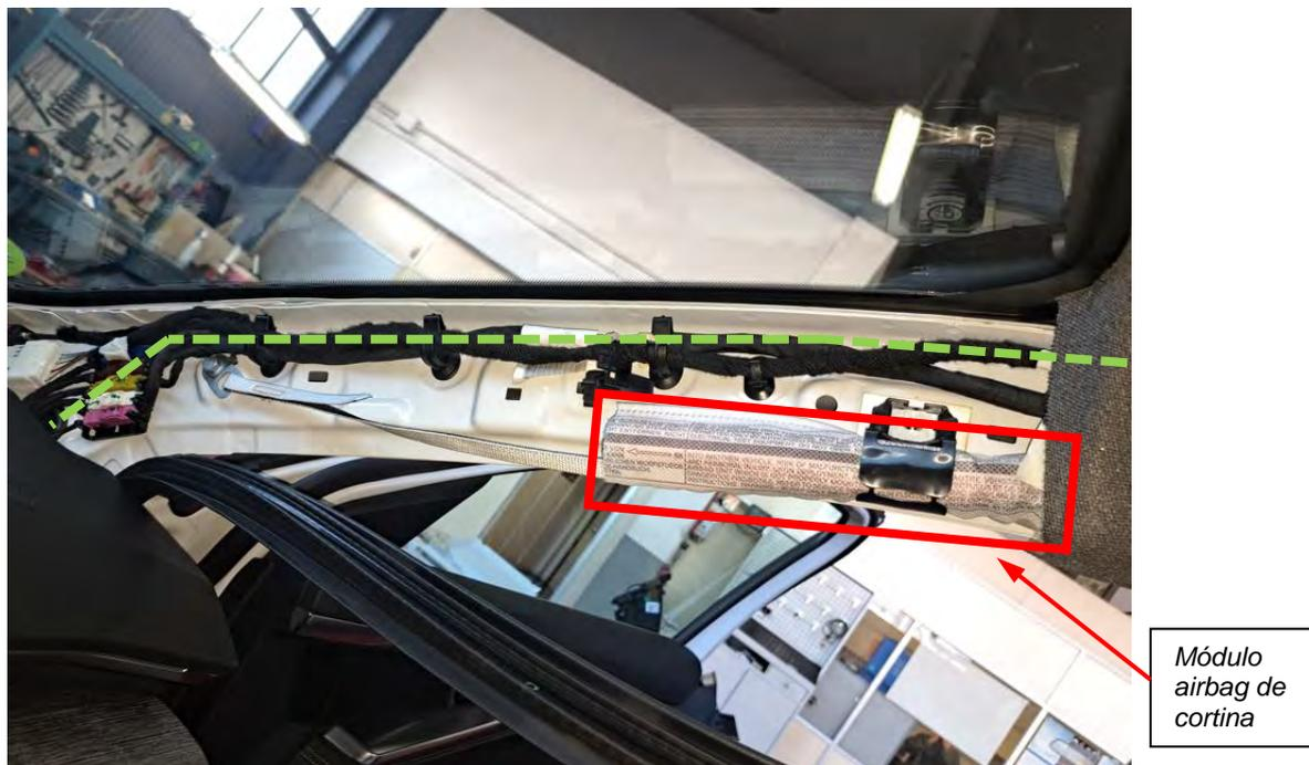
*Fig. 6.2.3. Recorrido de los cables por el interior pilar A derecho.*
