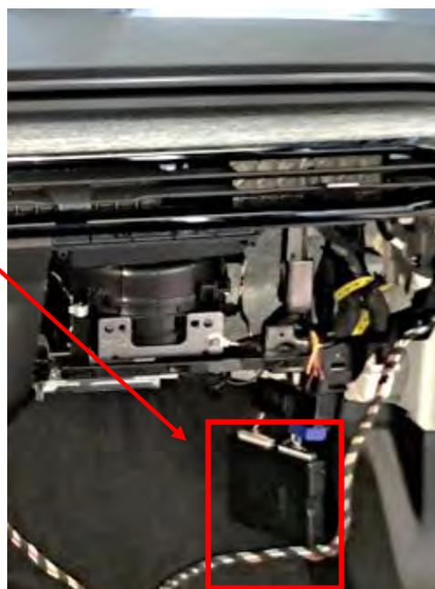
*Fig. 1.2. Detalle del calculador de Climatización (órgano 419)*
