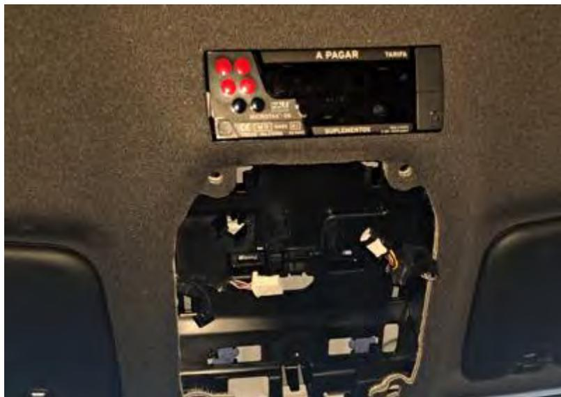
*Fig. 4.2.3. Taxímetro de consola simple de techo instalado.*
