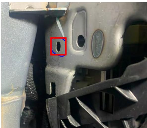
*Fig. 1.6. Detalle orificio para conexión masa.*
