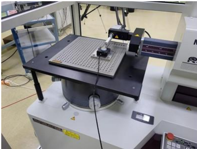
Montaje experimental para la calibración del palpador de la MMF del CEM mediante actuador piezoeléctrico.
