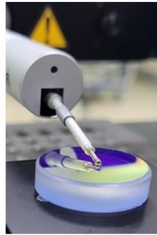
Montaje experimental para la calibración del palpador de la MMF del CEM mediante actuador piezoeléctrico.
