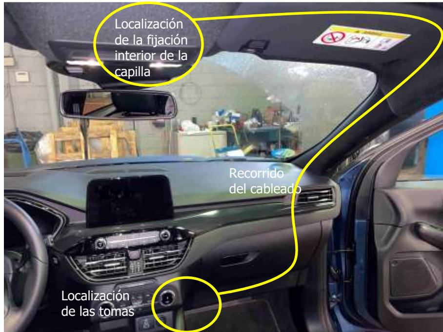
Las piezas o elementos que desmontar son las mismas que las descritas para la instalación del taxímetro en el retrovisor, por lo que recomendamos que la instalación del taxímetro y la capilla (módulo tarifario) se hagan a la vez. El trabajo añadido como comentamos será el desmontaje total del guarnecido interior del techo y para ello habremos de desmontar los guarnecidos de los pilares A, B y C/D.
