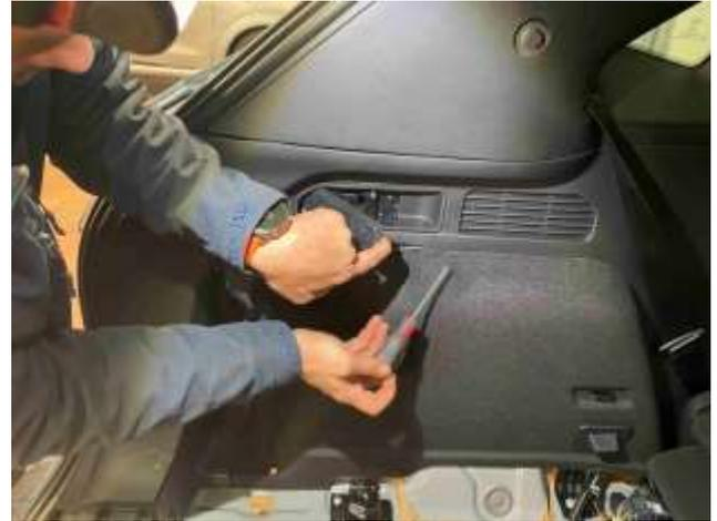
Al igual a como nos pasaba con el guarnecido del pilar B, hemos de desmontar también aquí usando una espátula los guarnecidos inferiores de los umbrales de la puerta trasera ya que estas piezas solapan el guarnecido del pilar C que queremos desmontar.
