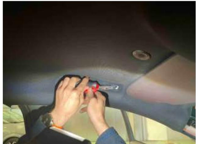
Desmontados los asideros del techo de la Fila 1 y los parasoles, procedemos ahora a desmontar las conexiones eléctricas del cuadro de las luces de cortesía.
