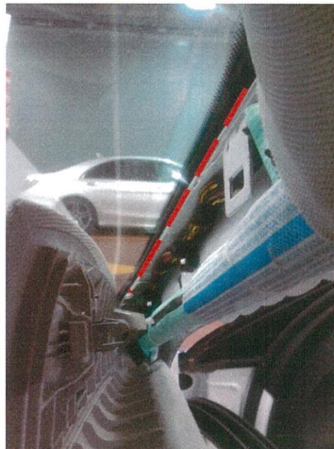
El paso del cableado NO interferirá de modo alguno con los airbags del vehículo, para ello el cableado que se añade irá convenientemente encintado al cableado ya existente.
