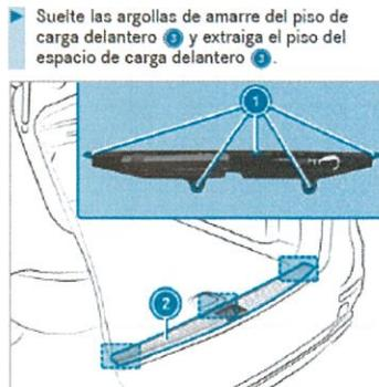
▶ Suelte las argollas de amarre del piso de carga delantero (1) y extraiga el piso del espacio de carga delantero (2).
