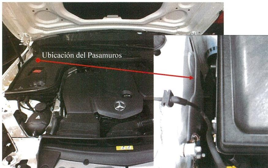
Una vez realizadas las conexiones eléctricas se vuelve a emplear el pasamuros para conectarlo con la preinstalación que se encuentra en la unidad de mando de techo. Se empleará el pilar A de la forma que se detalla a continuación.
