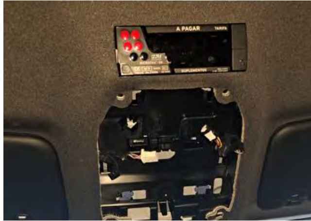
Fig. 4.2.3. Taxímetro de consola simple de techo instalado.
