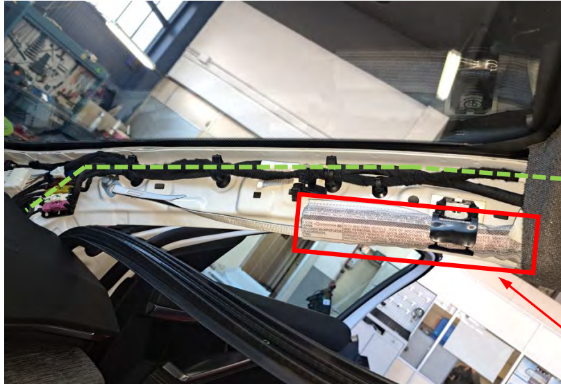
Fig. 6.2.3. Recorrido de los cables por el interior pilar A derecho.
