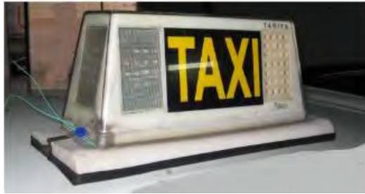
Fig. 6.1.3. Vista del módulo y su precinto
