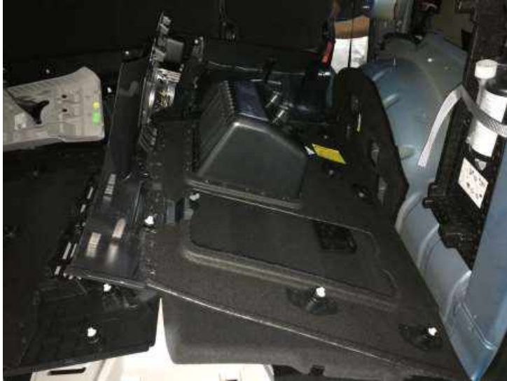
Desmontado este lateral, quitamos el pilar C
