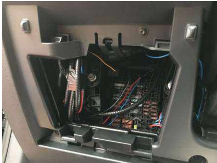
Localización de los cables para la posterior instalación de taxímetro en el retrovisor
