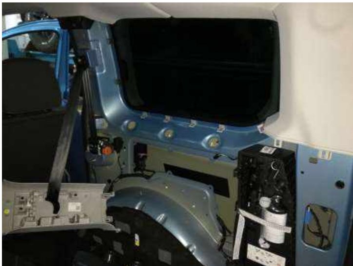
Desmontado este lateral, quitamos el pilar C
