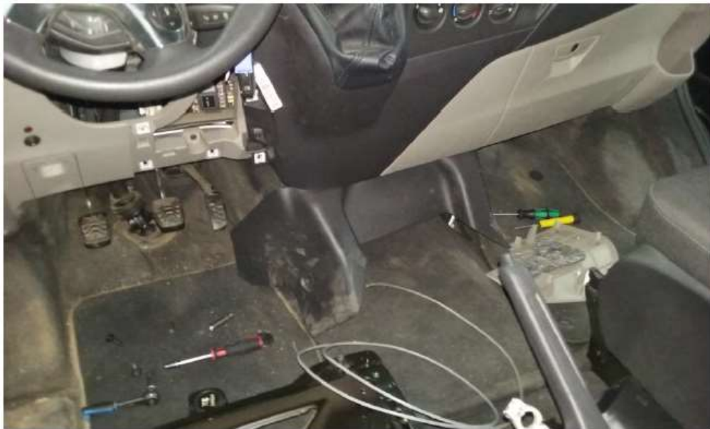
Desmontaje del Guarnecido inferior central
