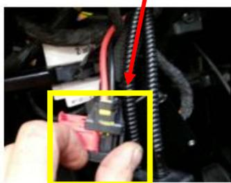
Se realizarán las conexiones a positivos con sus correspondientes fusibles aereos y un negativo de masa, protegiendo el cableado.
