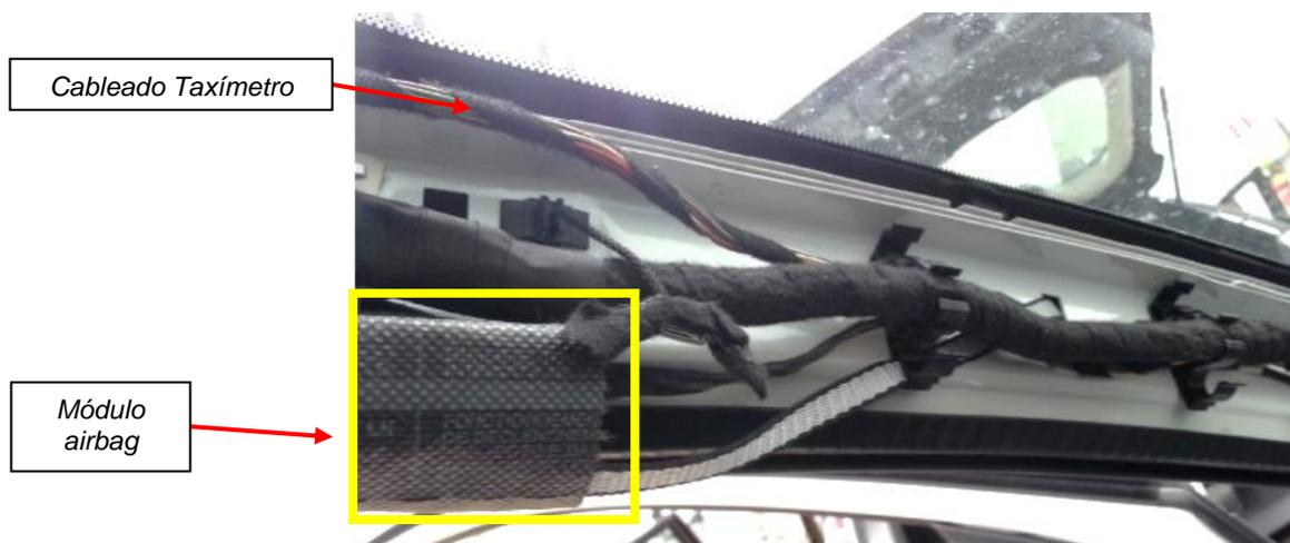
Por el interior del pilar A fijaremos el mazo de conexiones en las grapas libres que van situadas en el mismo montante. Bajaremos el cable por todo el montante hasta la junta de puerta, por el interior de ésta, meteremos el cable hasta la zona de la caja adaptadora de señal.
