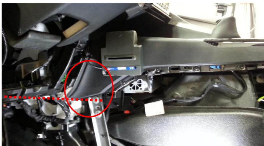
**IMPORTANTE:** El mazo de conexiones de la impresora deberá discurrir por el interior de guarnecido del pilar A siempre por encima del módulo de airbag lateral y asegurando la no interferencia del mismo con la zona de despliegue del airbag.
