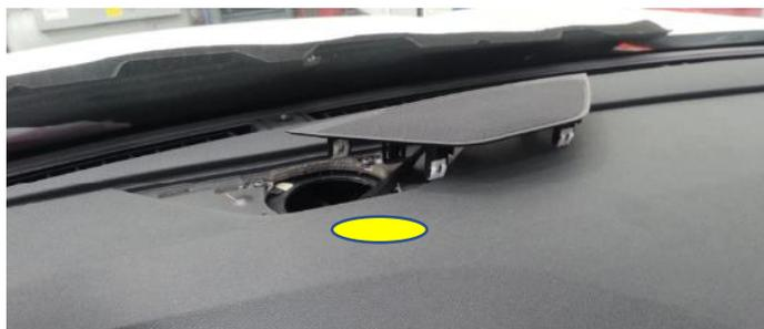
Una vez realizado el taladro, llevaremos la guía pasacables desde el taxímetro hasta la zona de emplazamiento de la caja adaptadora, por el interior del salpicadero, para proceder a encaminar las mangueras de cables (Manguera blindada, alimentación y señal de la caja adaptadora, módulo tarifario, etc).
