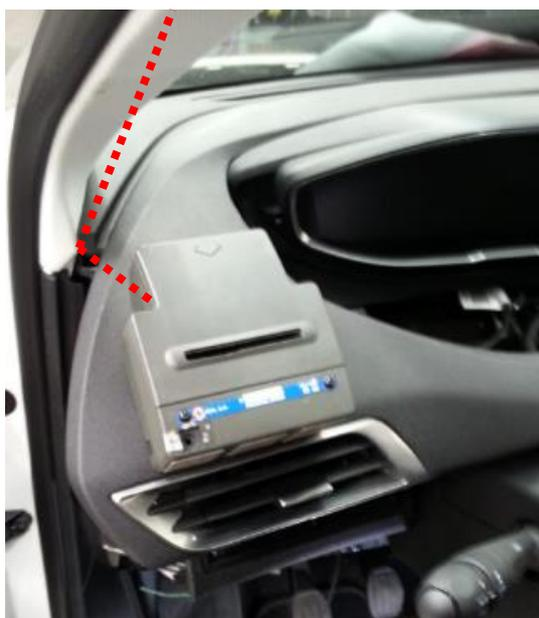
**IMPORTANTE:** El mazo de conexiones de la impresora deberá discurrir por el interior de guarnecido del pilar A siempre por encima del módulo de airbag lateral y asegurando la no interferencia del mismo con la zona de despliegue del airbag.
