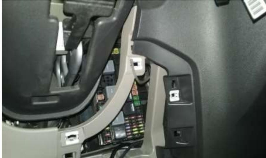
El uso de esta guía nos permitirá el paso de los cables del taxímetro desde el aparato a las tomas de la preinstalación del fabricante y de la manguera blindada a la parte superior del Salpicadero.
