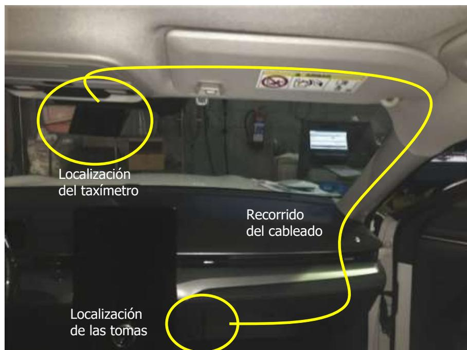
Del taxímetro pasaremos los cables por el guarnecido del techo en su zona delantera hasta llegar al pilar A, por donde bajaremos a encontrarnos con el lateral del salpicadero y pasando al interior de éste accedemos al cuadro de fusibles donde se encuentran los cables de la preinstalación. Este recorrido se puede hacer también en sentido contrario.
