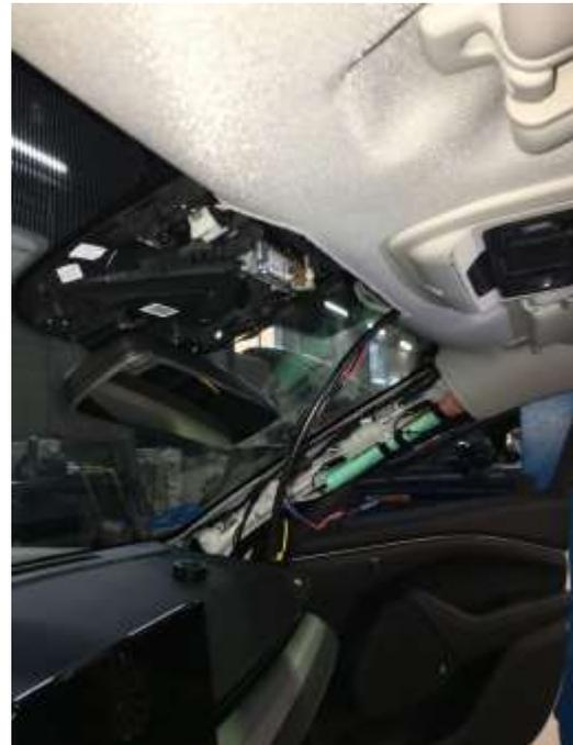
En este punto se llevaría a cabo la unión de estos cables con los que traería el taxímetro. Mención especial para el cable de la señal, que una vez conectado se habrá de precintar.
