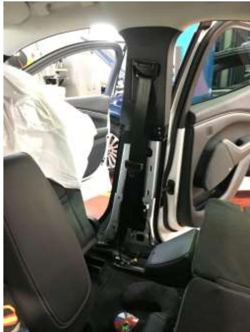
Desmontaje del guarnecido inferior dcho. del pilar B
