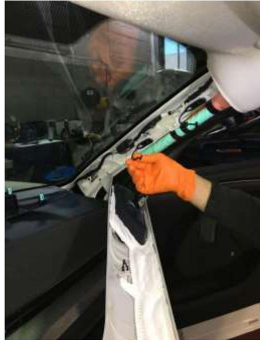
Conforme avanzamos desmontando elementos, vamos pasando el cableado:
