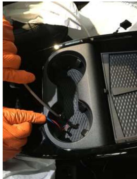
La fijación de la impresora en el alojamiento del vaso se puede hacer mediante adhesivos, velcro o pletinas remachadas o atornilladas.
