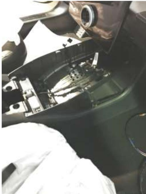
Con la parte superior del conjunto de la consola central desmontada, procederemos ahora a pasar los cables hasta esta zona desde el cubre pies del copiloto. Para ello desmontaremos los guarnecidos necesarios y usaremos una guía flexible para el paso por los interiores de la consola.
