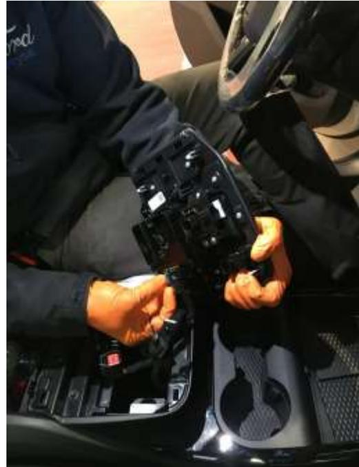
La consola va fijada al cuerpo inferior mediante 4 tornillos que hemos de quitar.
