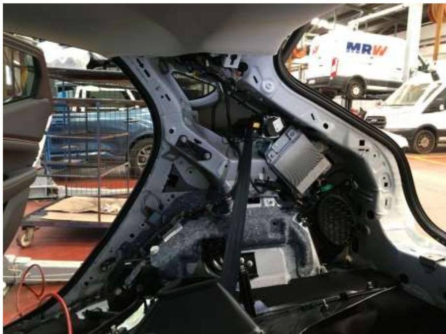
En este punto tenemos el guarnecido del techo sujeto al techo ya solo por los imanes interiores y los pilares C y D del lado del conductor que visto el trabajo que da su desmontaje (por el desmontaje asociado del respaldo del asiento trasero) decidimos mantener, eso sí, manteniendo el cuidado del guarnecido en esa zona no desmontada.
