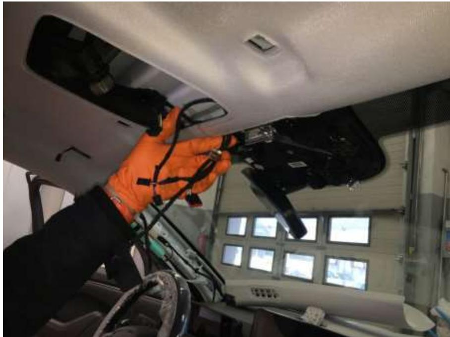
Llegados a este punto ya tenemos desanclado del techo el guarnecido en su parte delantera. Como hemos dicho anteriormente, habremos de desmontar todo el guarnecido del techo por lo que a continuación procederemos al desmontaje de los guarnecidos laterales de los pilares B, C y D, los asideros de la fila 2 así como partes de la zona trasera dedicada a la zona de carga.
