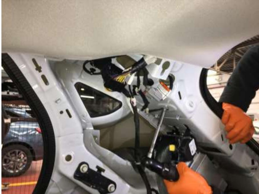
Desenganchando estas clemas y la toma de masa permitimos que el guarnecido caiga sin problemas de quedar enganchado a algún elemento del techo interior del vehículo.
