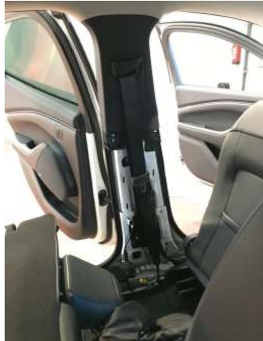
Desmontaje del guarnecido inferior izdo. del pilar B
