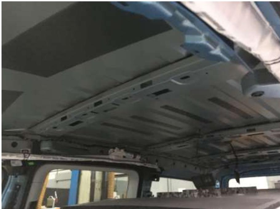
Nos situamos en la fila 1 del vh. y buscando el centro longitudinal del mismo, planteamos la zona de fijación de la capilla, donde se practicarán los taladros para la fijación mediante tornillos de la misma.
