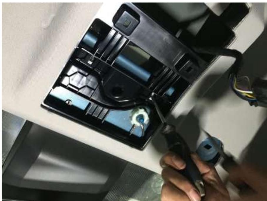
Llegados a este punto ya tenemos des anclado del techo el guarnecido en su parte delantera. Como hemos dicho anteriormente, habremos de desmontar todo el guarnecido del techo por lo que a continuación procederemos al desmontaje de los guarnecidos laterales de los pilares B, C y D, así como de la zona trasera dedicada a la zona de carga.
