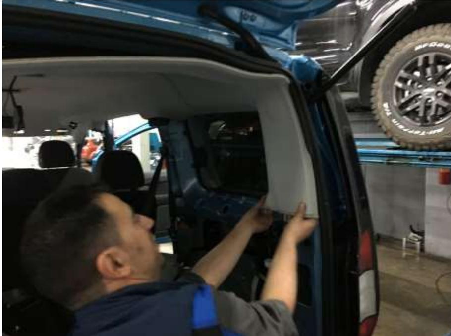
Desmontados los pilares D de cada lado tiramos del tapizado del techo hacia nosotros y debería salir de sus guías sin problemas.
