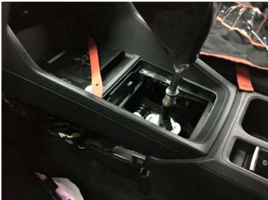
Y de la zona de la palanca de cambios a la de los portavasos... Habría que practicar un taladro en el lateral interior del portavasos para el paso de los cables que alimentan de energía y de datos a la impresora.
