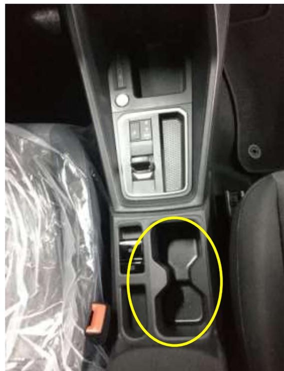
De la zona del cuadro de conexiones, por debajo del volante, llegaríamos al panel lateral de la zona de los pedales. En las siguientes fotografías se ven en detalle las zonas de paso cuyos guarnecidos habría que desmontar con el uso de espátulas y destornillador.
