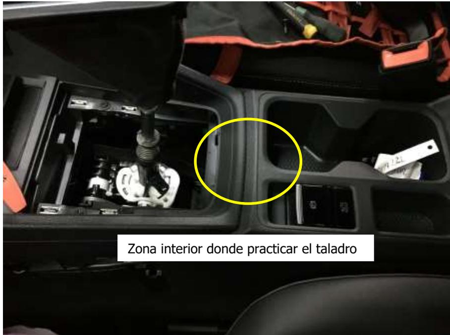
Los guarnecidos de esta zona van con grapas y/o tornillos de fácil acceso y manipulación. El uso de una guía flexible para cables facilita también el trabajo. Del mismo modo, el uso de bridas permite que el cableado no quede suelto en el interior, por lo que se recomienda su uso en la cantidad que el taller considere oportuno
