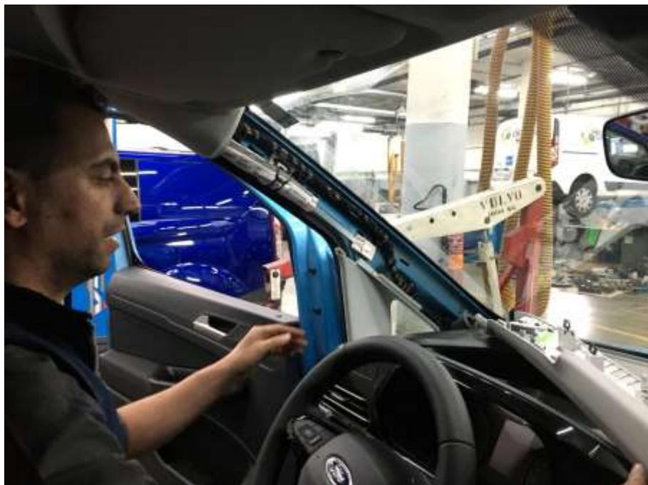
A diferencia del proceso con el taxímetro en el retrovisor, y dado que el módulo tarifario está localizado en el techo, aquí no nos es de utilidad la guía flexible sino que nos veremos obligados al desmontaje de todos los elementos que tenga el vehículo en el techo interior.
