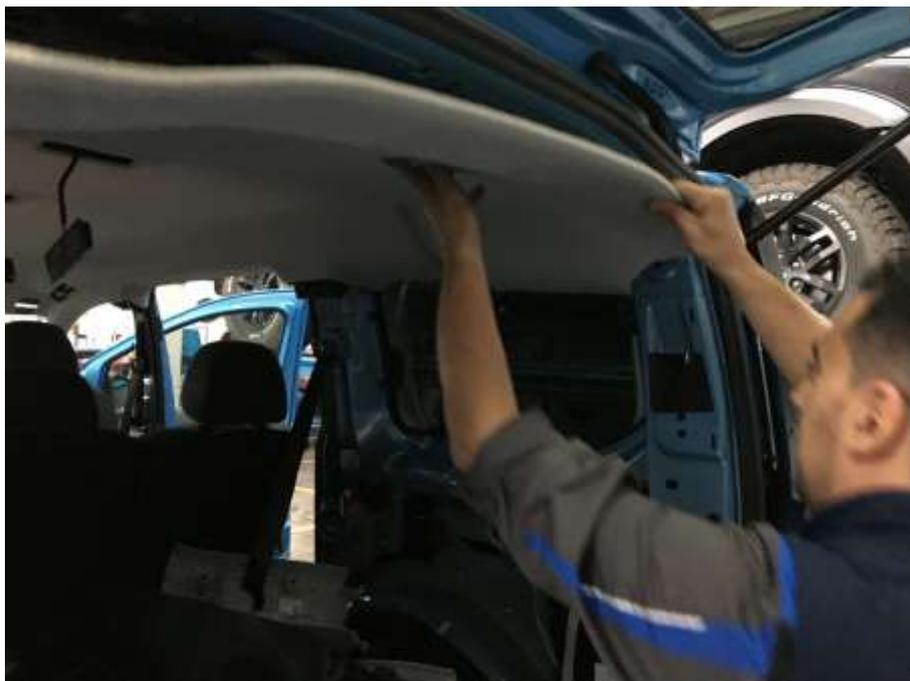
En estas fotos se muestra el tipo de fijación del tapizado del techo a los arcos interiores de la carrocería del vh.
