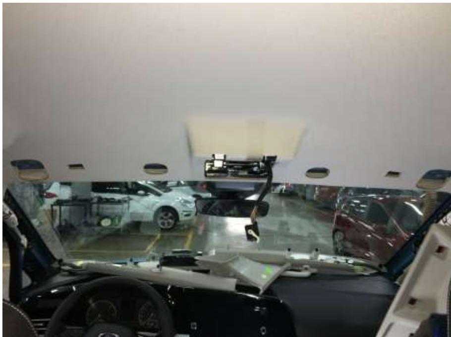
El guarnecido del techo, en su parte delantera, va fijado al techo mediante una pieza que a la vez servía de unión del cuadro de luces de cortesía antes desmontado. Esta pieza va fijada al techo mediante tornillos por lo que se requerirá el uso de un destornillador.
