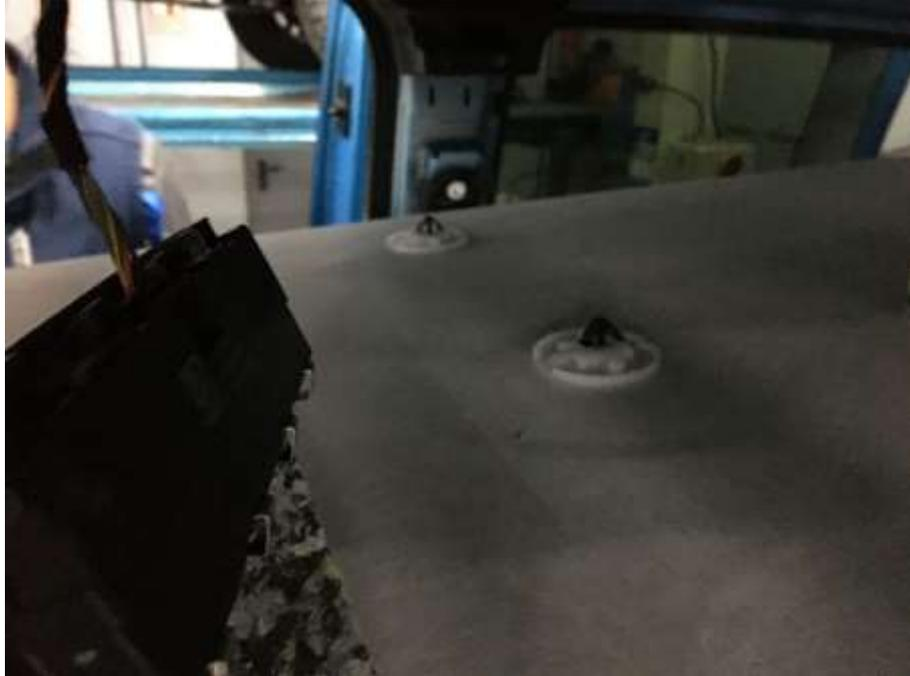
Una vez desmontadas estas piezas y elementos, tenemos el techo desnudo y listo para realizar los agujeros que fijarán el taxímetro en la posición adecuada y se procedería a la fijación de los tornillos que aseguran la capilla al vehículo.
