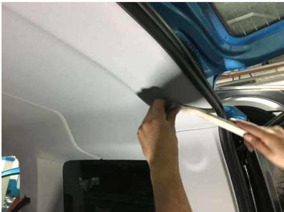
Y no nos olvidamos de desmontar con una espátula las luces de cortesía de las filas 2 y 3 o zona de carga.
