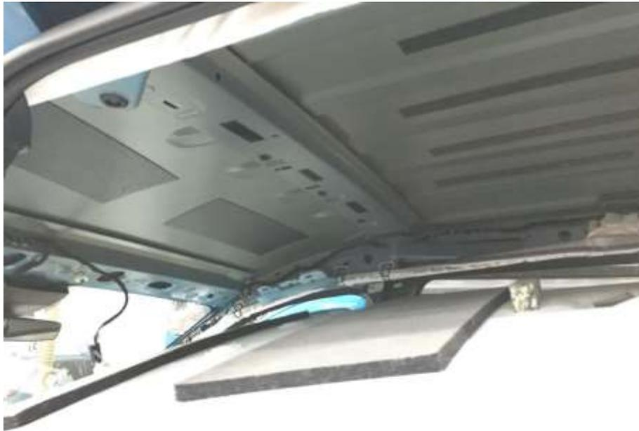
Las grapas de fijación se quitarán de los arcos del techo y se pondrán de vuelta en el tapizado para su montaje posterior, una vez se haya instalado la capilla en la zona al efecto.
