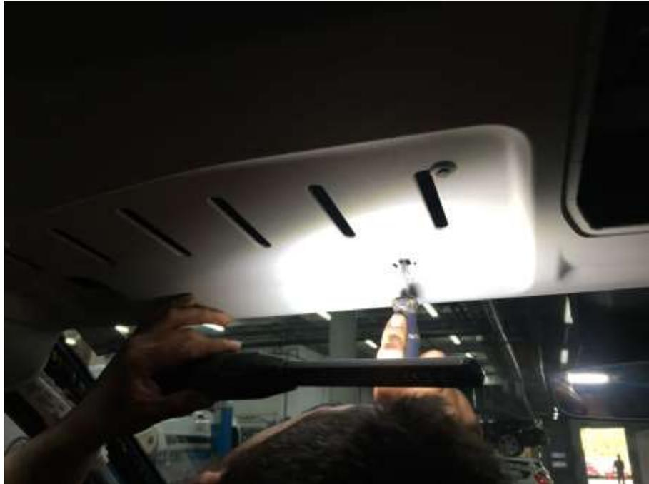
Desmontados los asideros del techo y los parasoles, procedemos ahora a desmontar el cuadro de las luces de cortesía, incluidas las conexiones eléctricas. Para este elemento se requiere el uso de una espátula.
