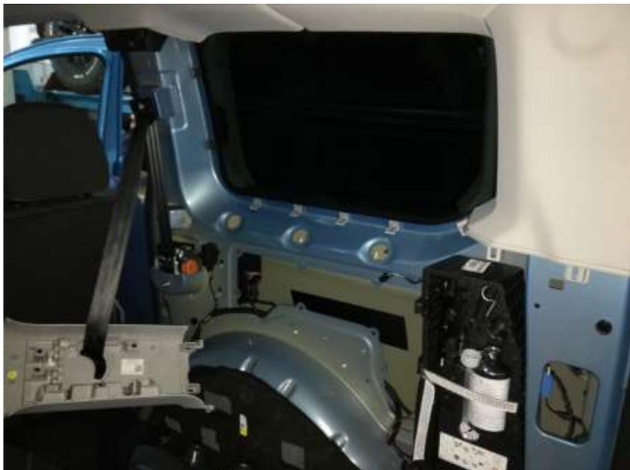
Nos vamos ahora a la parte trasera del vh. y desmontamos los tapizados del techo para seguidamente desmontar los pilares D de cada lado.
