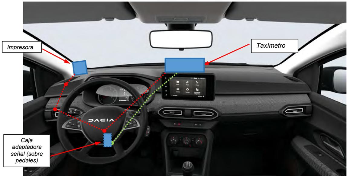
*Fig. 4.1.1. Esquema orientativo del recorrido de las conexiones para taxímetros sobre salpicadero .*
