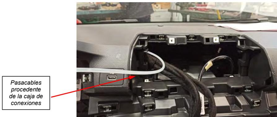
*Fig. 4.1.2. Vista del paso de cables por el interior del salpicadero*
