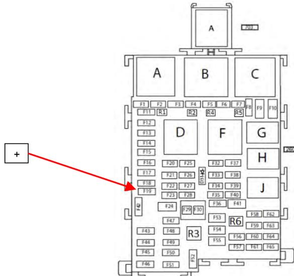
**Fig. 2.1.** Esquema de la Caja de Fusibles, indicando Nº 19.
