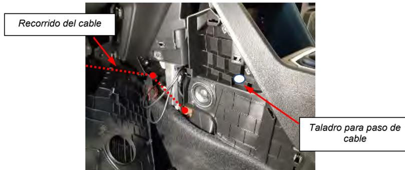
*Fig. 5.2.2. Recorrido cable impresora hueco portaobjetos central.*
