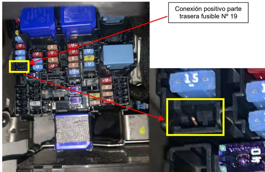
**Fig. 2.2.** Detalle de la Caja de Fusibles desmontada y acceso a conexión a fusible Nº 19
