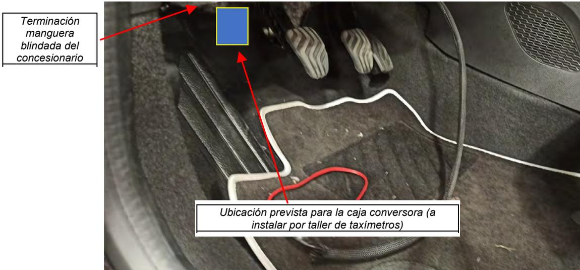
*Fig. 2.1.4. Detalle ubicación de caja convertora de señal.*
