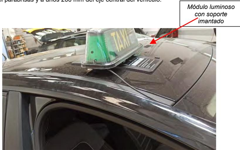
*Fig. 6.2.1. Vista del módulo luminoso desplazado sobre soporte imantado.*
