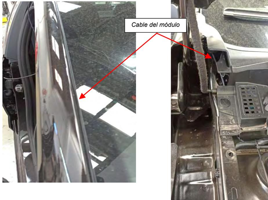
*Fig. 6.2.3 y 6.2.4. Vista del recorrido del cable módulo luminoso y entrada al cofre motor*
