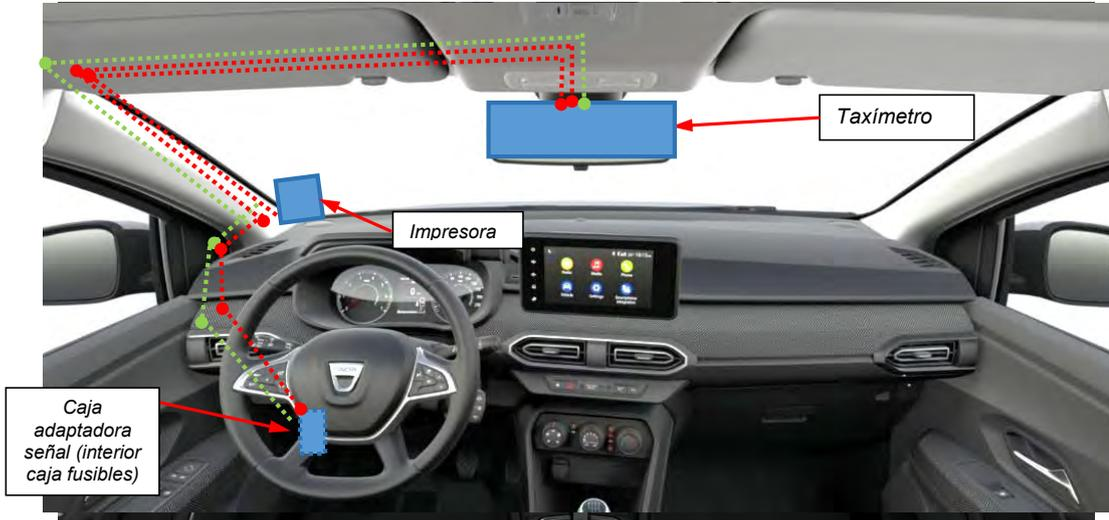
*Fig. 4.2.1. Esquema orientativo del recorrido de las conexiones para taxímetros de espejo.*
