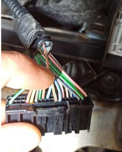
**Fig. 1.3.** Vista del conector 247 del cuadro de instrumentos
