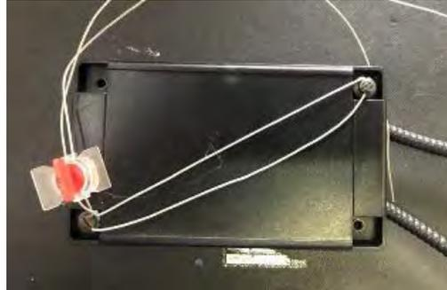
*Fig. 3.3. Detalle de la caja de conexiones precintada.*
