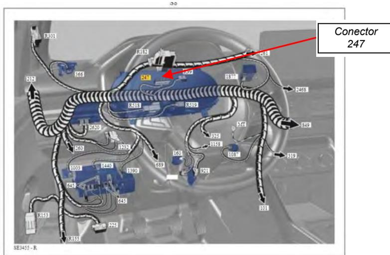
**Fig. 1.1.** Esquema general de conectores, zona del conductor.
