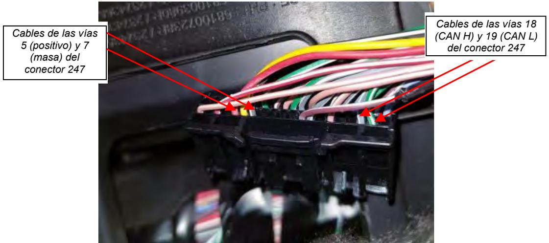
**Fig. 2.1.1. Detalle vías 18 (CAN H), 19 (CAN L), 5 (positivo) y 7 (masa) del conector 247**
