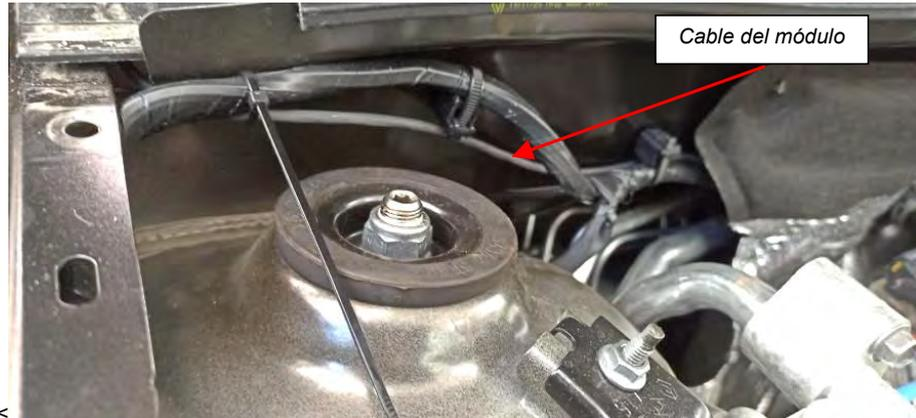
*Fig. 6.2.5. Vista del recorrido del cable módulo luminoso por el cofre motor*
