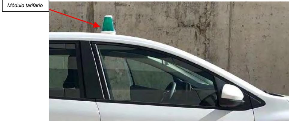
*Fig. 6.1.2. Vista lateral ejemplo módulo centrado atornillado*
