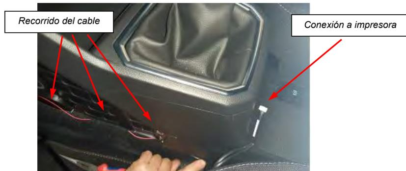
*Fig. 5.2.2. Recorrido del cable por el interior del guarnecido central.*
