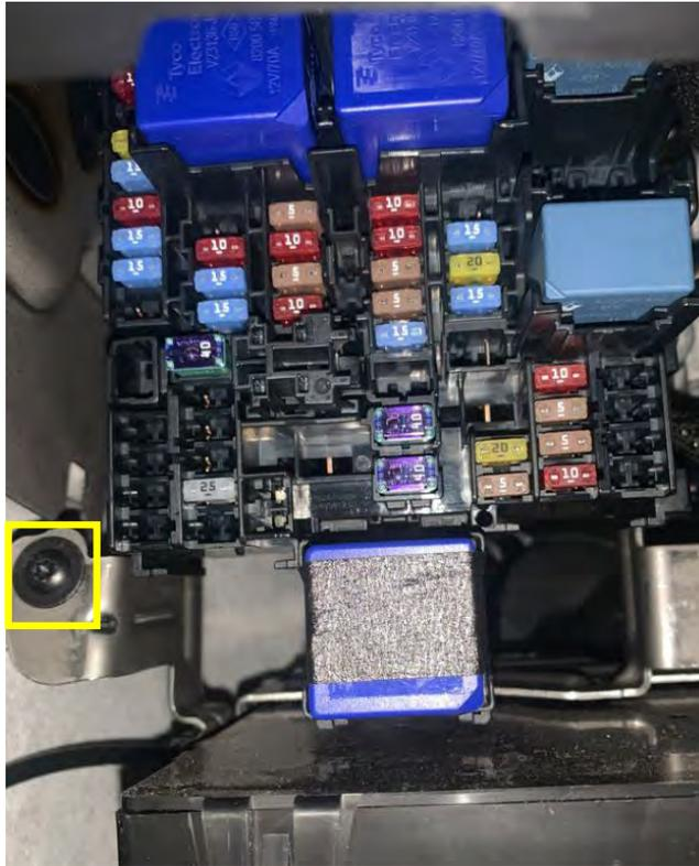
*Fig. 2.3. Detalle de conexión negativo de masa a chasis.*
