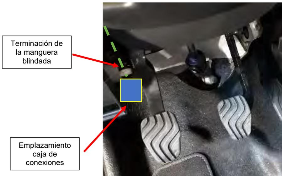
**Fig. 3.1.** Vista de la terminación de la manguera blindada puesta por el concesionario
