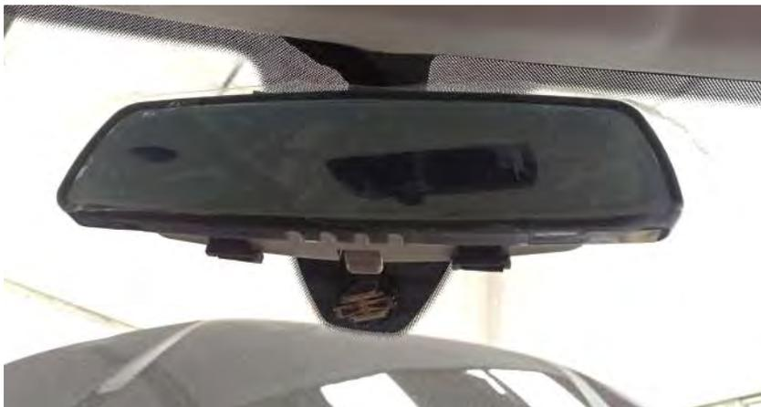
*Fig. 4.2.1.2. Vista del taxímetro de espejo*
