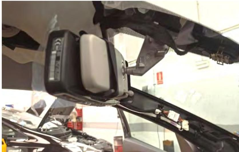
*Fig. 4.2.1.3. Vista de taxímetro de espejo superpuesto.*
