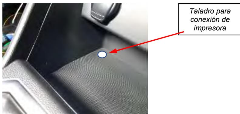
*Fig. 5.2.3. Taladro para paso del cable por el interior del hueco portaobjetos central.*
