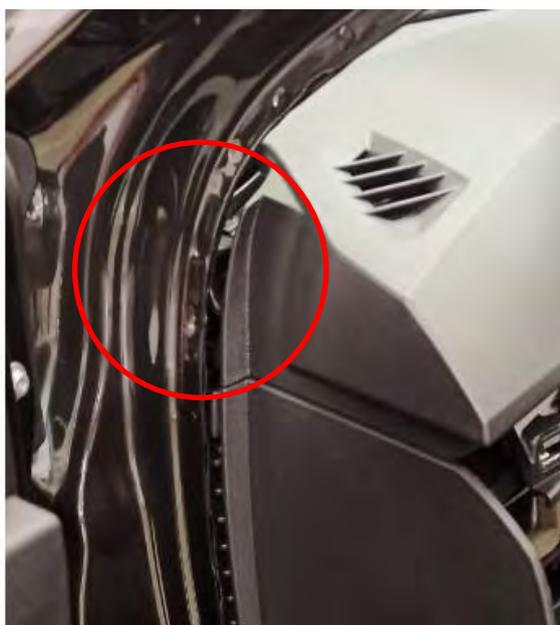
*Fig. 4.2.2. Zona de paso del cableado*
