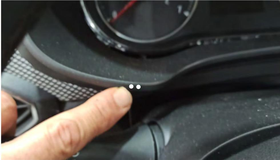
*Fig. 2.2.2. Identificación de los taladros para el paso de alambre de precinto.*
