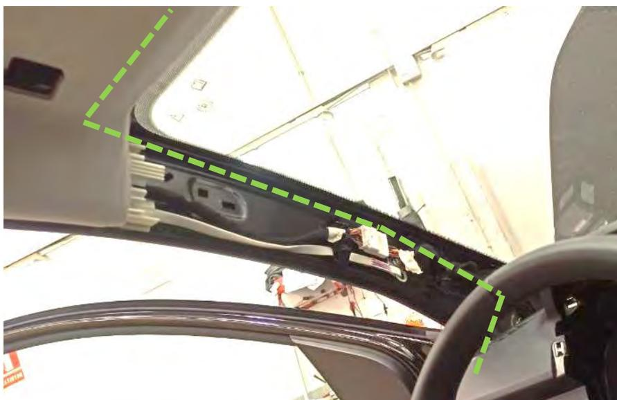
*Fig. 4.2.3. Recorrido de los cables por el interior del guarnecido del marco del parabrisas.*
